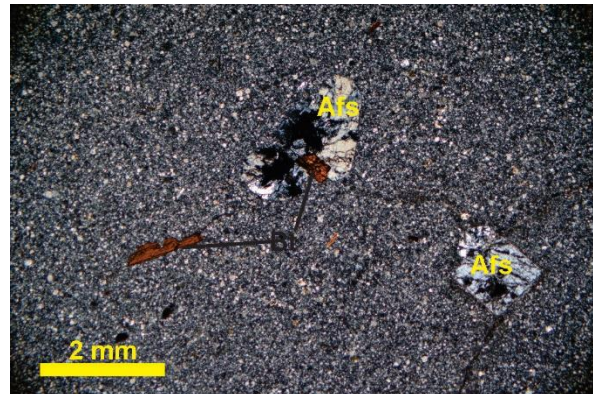
Fig. 40. Fotomicrografía de la litofacies //sT, nícoles cruzados. Se observa que el principal componente es ceniza alterada, se observan cristales de feldespato potásico (Afs) y biotita (Bt) fracturados.
