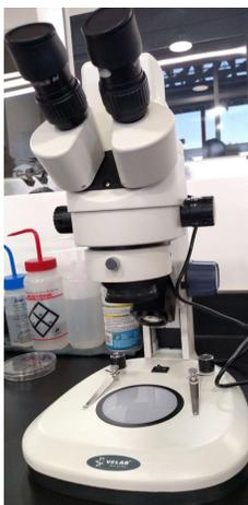
Figura 6.5: Microscopio estereoscópico VELAB™ VE-S5C
