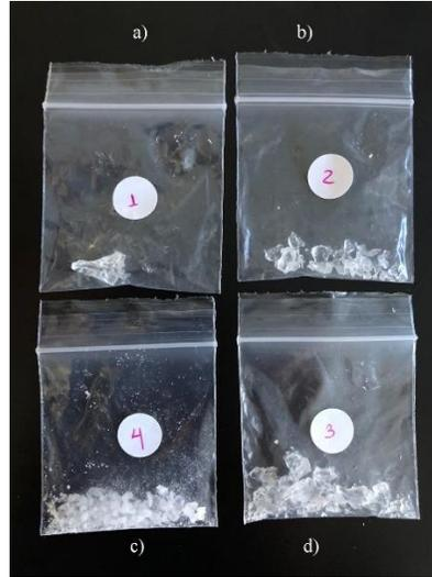
Figura 35. Muestras de los hidrogeles en seco; a) M1, b) M2, c) M3, d) M4.
