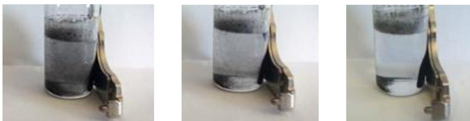
*Figura 53. Síntesis de NPs de óxido de hierro inmersas en agua destilada. En las imágenes se puede observar el efecto de un campo magnético externo.*
