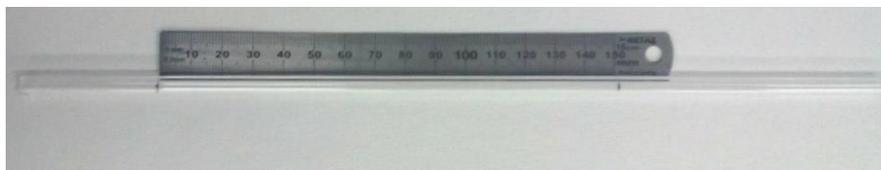
Figura 32. Columna de vidrio que se utilizó para medir los tiempos que tardan los polímeros en atravesarla. La columna tiene una longitud  $l = 28.5$  cm y radio  $R = 0.2$  cm, a la cual se le marcó dos líneas indicando una altura  $h = 15$  cm
