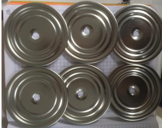
Fig. 12 Orificios para colocación de termopares.
