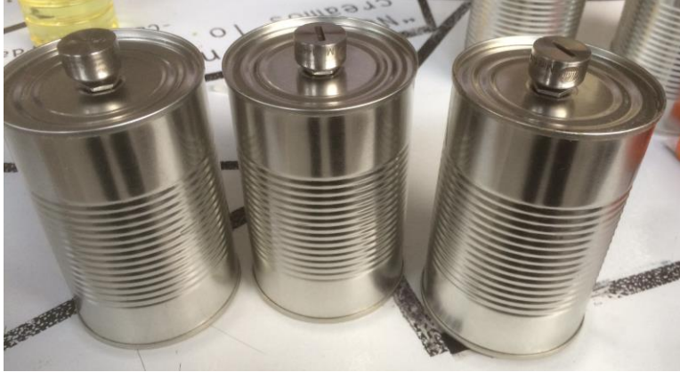
Fig. 13 Colocación de termopares en latas antes de ser sometidas al proceso de esterilización comercial.
