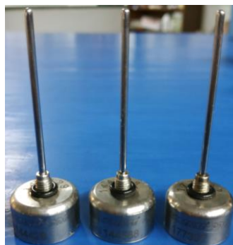
Fig. 8 Termopares tipo T de la Marca Ellab
