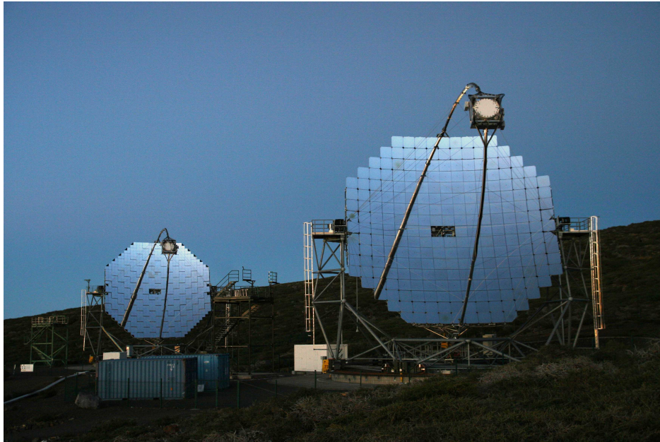
Figura 3.2: El arreglo de telescopios del sistema de telescopios MAGIC que consta de dos IACTs de 17 metros de diámetro, localizado en el Observatorio Roque de los Muchachos en La Palma. [19]
