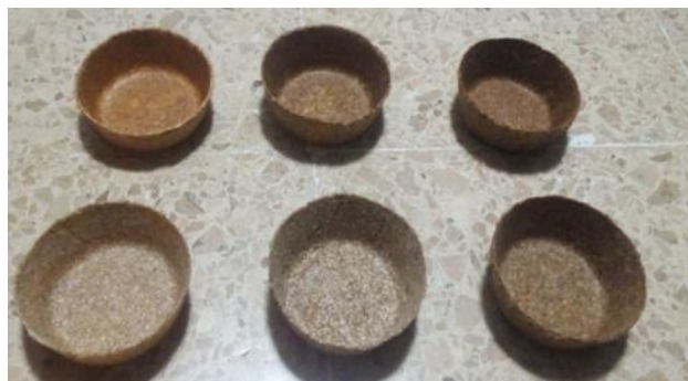
Figura 13. Aspecto de los platos de bagazo de malta y harina de yuca sometidos a dos tipos de secado (horno y secador solar), barnizados con dos tipos de recubrimiento (carnauba y candelilla)
