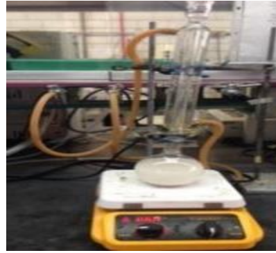
Fotografía 8. Elaboración de disolvente MAC (Metanol:Agua:Cloruro de Calcio) en una relación 1:4:1
