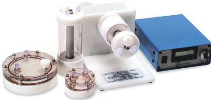
Figura 6: Imagen de un biorreactor utilizado para formar organoides. Imagen traída por (Navran, 2006).
