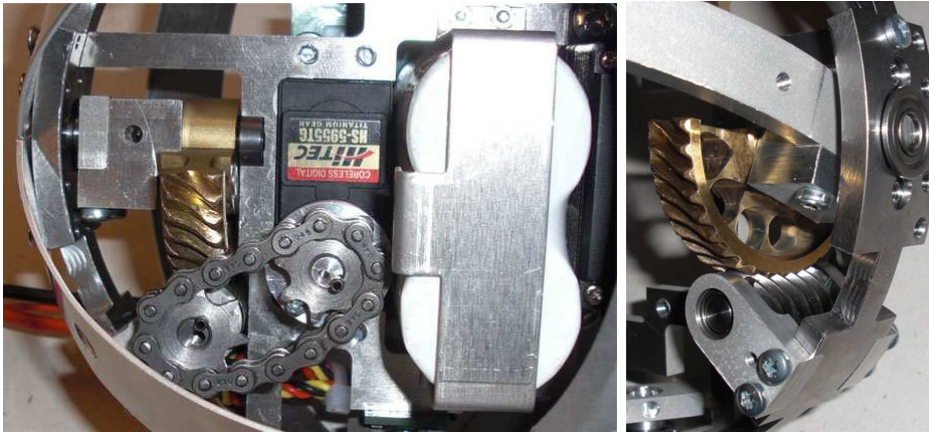
Figura 2.5 Transmisión de cabeceo del robot Kulko. Catarina-cadena (izquierda) en la primer etapa y tornillo sinfín y corona (derecha) en la segunda.
