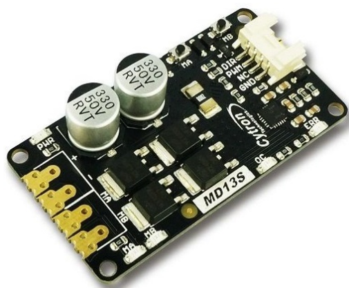
Figura A.4 Puente H Cytron MD13S.
