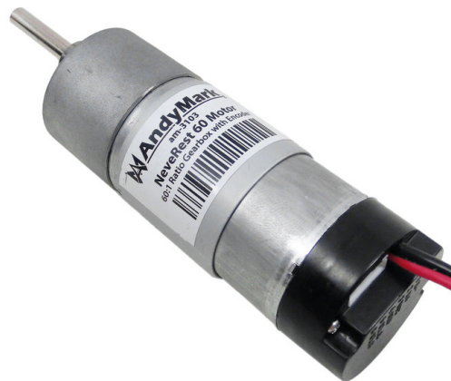
Figura 3.7 Moto-reductor NeveRest 60 usado para las transmisiones de cabeceo de carga media.
