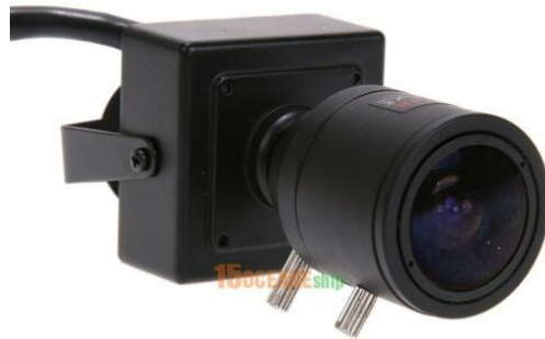
Figura 4.6 Mini cámara IP usada para la transmisión de vídeo desde el robot serpiente.
