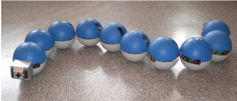
Figura 2.3 Robot serpiente Kullo desarrollado por la Universidad Noruega de Ciencia y Tecnología.
