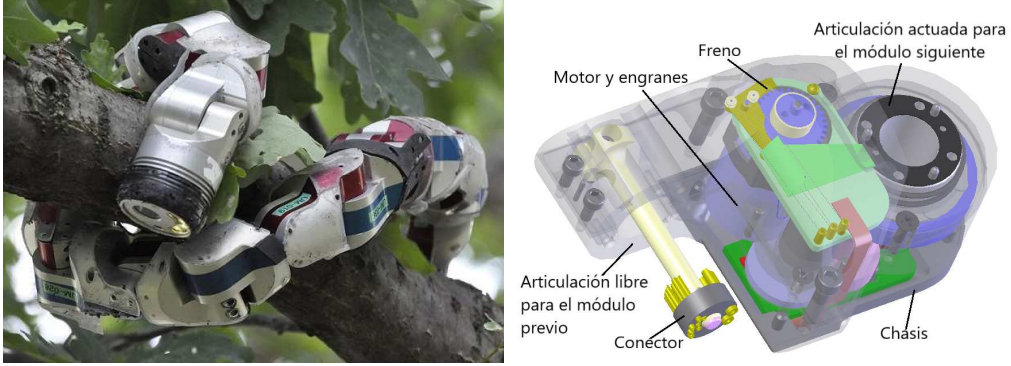
Figura 2.6 Robot Serpiente Unificado. Trepando un árbol (izquierda). Composición de uno sus módulo (derecha).
