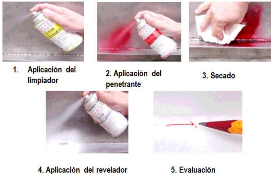
Figura 3.9 Pasos para detección de fugas en soldaduras por líquidos penetrantes.
