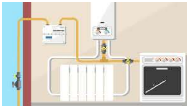
Figura 3.3 Válvula de corte general de una instalación de aprovechamiento tipo residencial. Fuente: Naturgy
