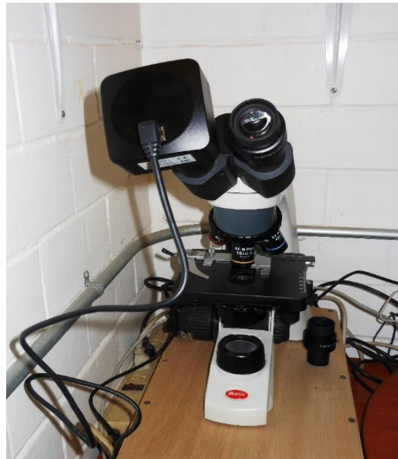
Figura 27. Cámara VE-LX1400 adaptada a microscopio óptico.
