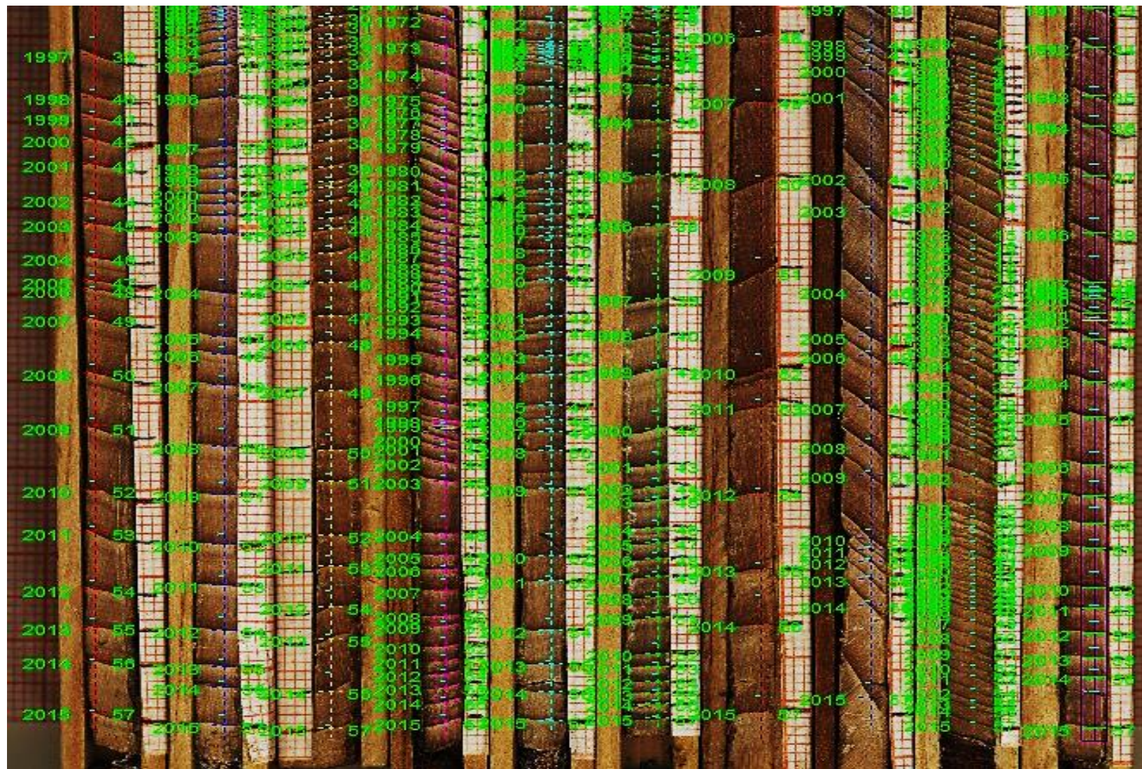
Figura 24. Medición de anillos con WinDENDRO™.
