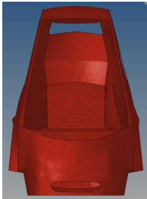
Figura 2.28 Vista frontal del modelo del espacio de diseño mallado
