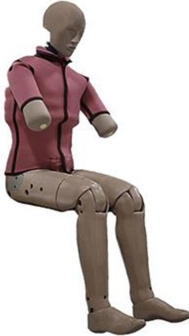
Figura 5.3 Dummy ES-2RE, utilizado en pruebas de Side barrier impact. Su antropometría corresponde a un percentil 50 [5.2]
