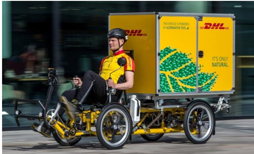
Figura 1.5 Pedelec usado por DHL para el transporte de paquetería. Su capacidad de carga es de hasta 125 [kg] [1.15].
