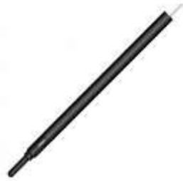
**Figura 2.10.** En la imagen se muestra una fotografía de una cámara de ionización modelo A12. El volumen sensible de la cámara se encuentra en la parte inferior. El otro extremo se conecta a un electrómetro para la lectura de carga colectada.
