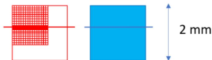
**Figura 5.1.** Se muestra la resolución espacial de la película radiocrómica en rojo, en comparación a la resolución dada por el algoritmo de cálculo Monte Carlo en color azul. Las regiones llenas de color representan el área que se toma para comparar con los perfiles. Particularmente, por un valor en la distribución calculada, se tienen 28 líneas posibles en la película (usando una resolución de 300 puntos por pulgada para la lectura de la película).
