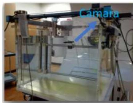
**Figura 3.2.** Maniquí de agua y colocación de cámara de ionización para la dosimetría de referencia.
