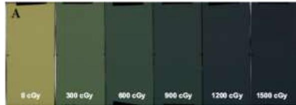
**Figura 2.13.** Cambio del oscurecimiento de la película EBT3 como respuesta a la radiación ionizante. Se observa una relación entre el oscurecimiento de la película y la dosis absorbida.
