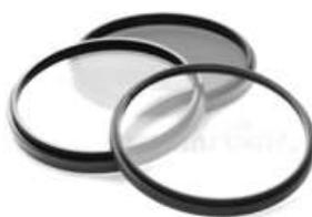
**Figura 3.6.** Filtros ópticos usados para evaluar la reproducibilidad de la luz blanca entre lecturas tomadas en tiempos diferentes (días, semanas y después de un mes).
