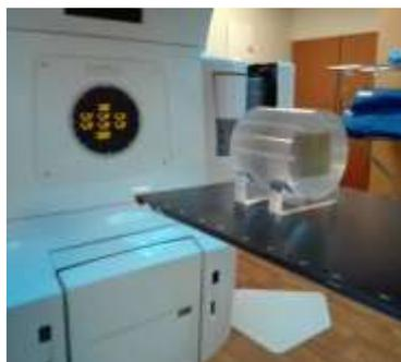
**Figura 3.29.** Maniquí sobre la mesa del acelerador lineal, previo a al tratamiento.
