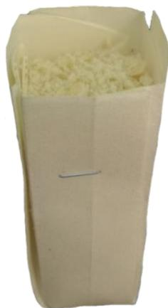
Figura 26. Extracción de aceite por el método de soxhlet: preparación del cartucho.
