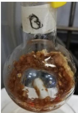
Figura 40. Reacción de transesterificación directa (*in situ*) de la semilla de *Jatropha*, relación en peso 1:0.5 [semilla] / [disolvente], empleando aceite de limón como disolvente.
