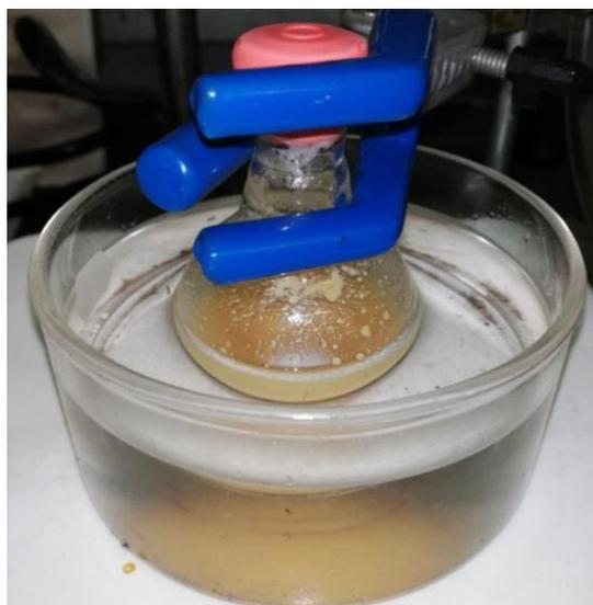
Figura 28. Extracción del aceite de la *Jatropha curcas* por el método de disolventes.
