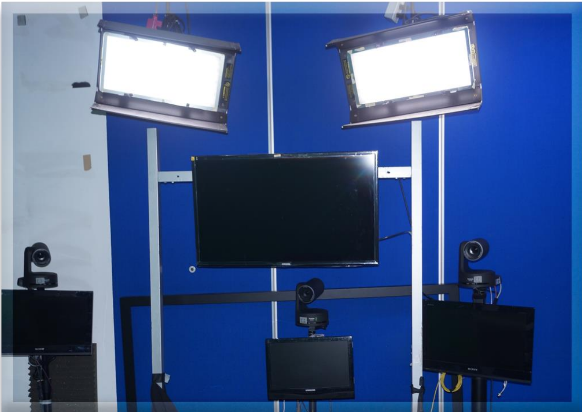
Luces Kino Flo fluorescentes de 5500°k del anexo del foro virtual
