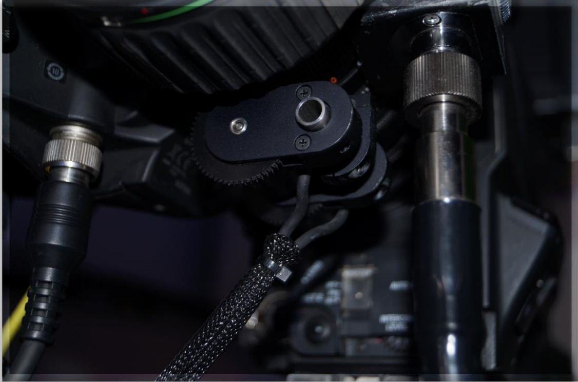
Sensor para zoom de SHOTOKU en cámara SONY 1500, lente Canon Y120
