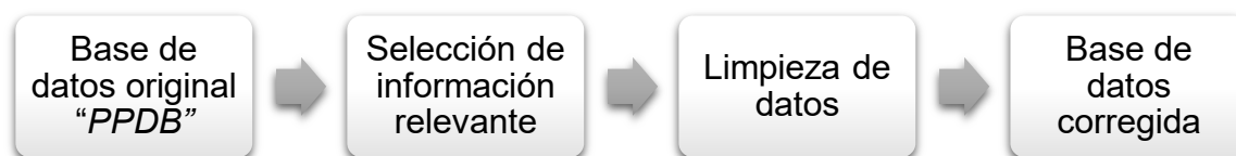
Figura 1. Diagrama de flujo para la preparación de la base de datos.
