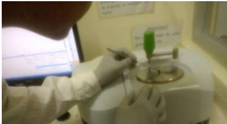
Figura 12.- Colocación de la muestra sobre el cristal de diamante del equipo.
