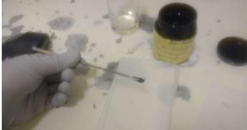
Figura 11.- Toma de muestra de hidrocarburo
