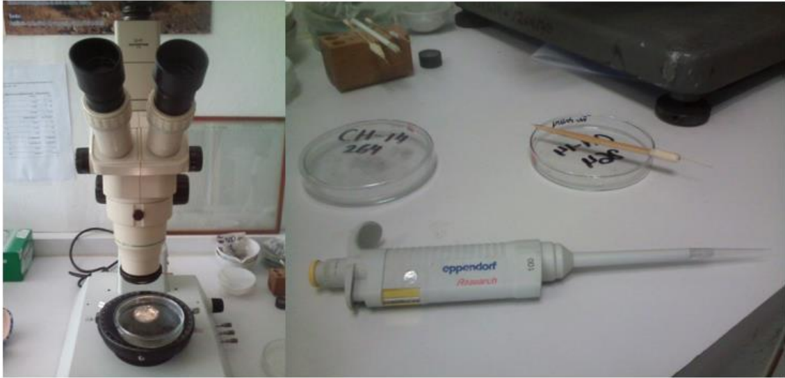
Fig. 3. 7 Materiales empleados para la separación manual de circones detríticos del Laboratorio Universitario de Geoquímica Isotópica.
