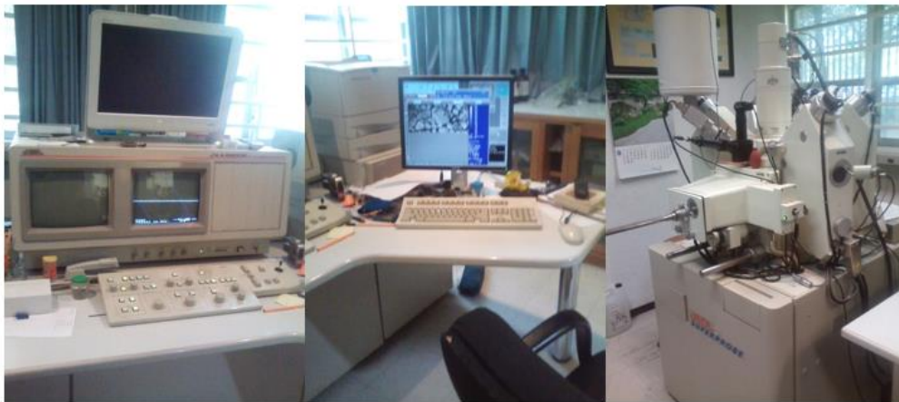
Fig. 3. 6 Equipo de microscopia electrónica de barrido con espectrometría de energía dispersa del Laboratorio Universitario de Petrología.
