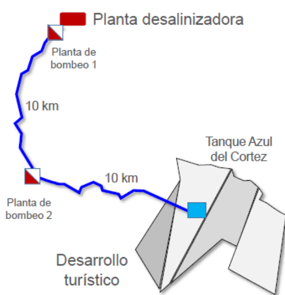
Imagen 3. Componentes de la Desalinizadora La Paz
