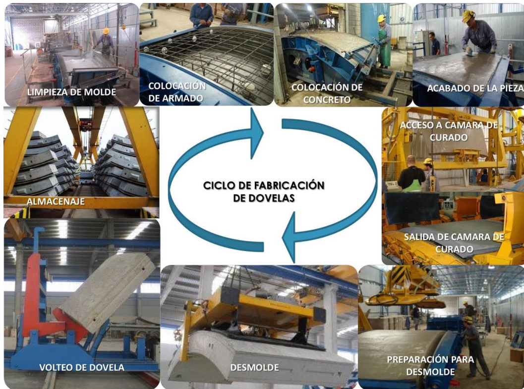
Figura 3.13 Ciclo Sistematizado de la fabricación de las dovelas.
