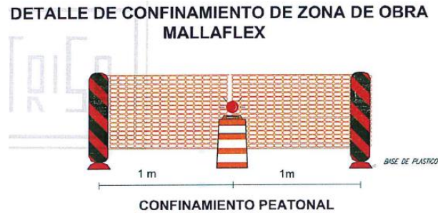
Figura 2.6 Esquema para la colocación de mallaflex.
