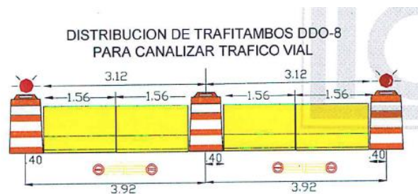
Figura 2.5 Esquema para la colocación de trafitambos.
