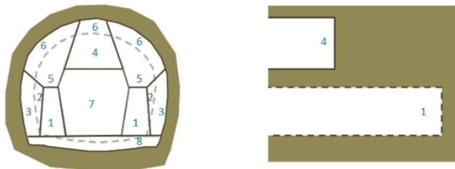
Figura 1.9 Esquema del sistema de excavación alemán.
