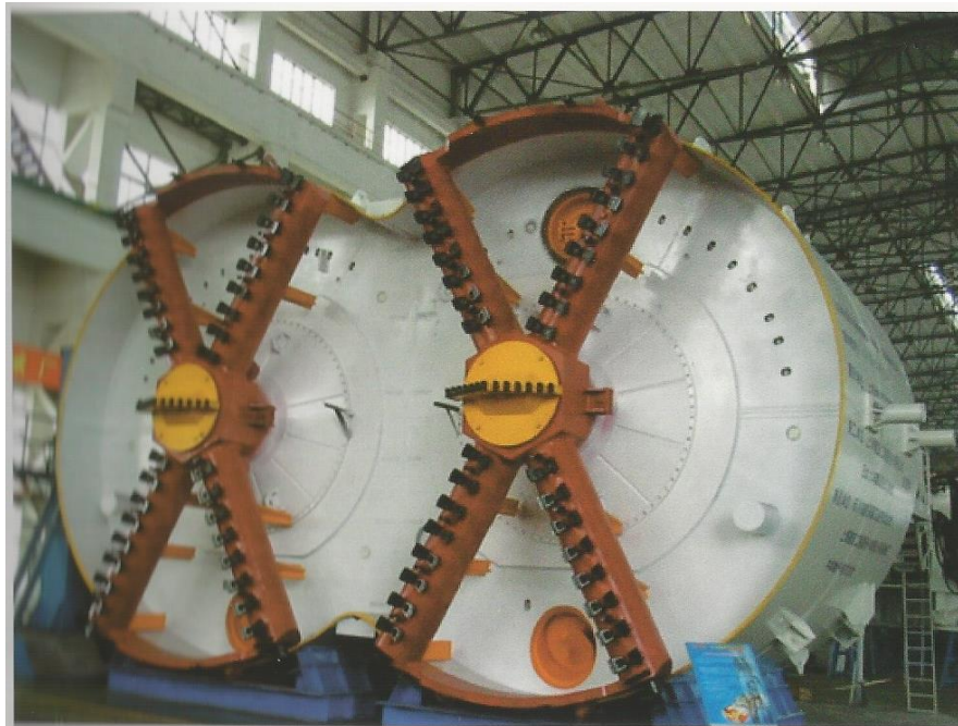
Figura 1.11 Imagen de la tuneladora melliza, utilizada en Shanghai, China.
