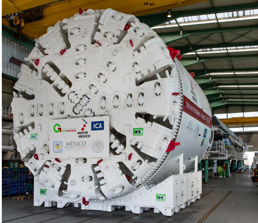
Figura 3.2 Imagen de la tuneladora que se usó en el proyecto.
