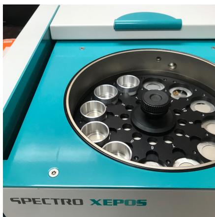
Figura 2.6: Vista superior equipo de fluorescencia de rayos X, *SPECTRO XEPOS III*, del LGIG.
