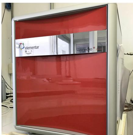
Figura 2.7: Analizador elemental de carbono y nitrógeno *Vario Micro Cube*, *Elementar*, empleado en el LGIG.
