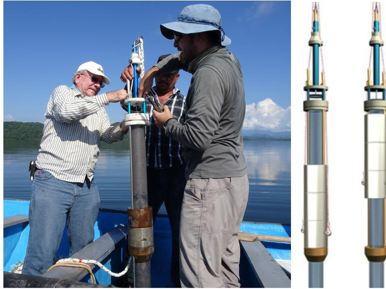
Figura 1.3: Izquierda: muestreo de un núcleo sedimentario en un ambiente lacustre. Derecha: nucleador [UWITEC, 2019].
