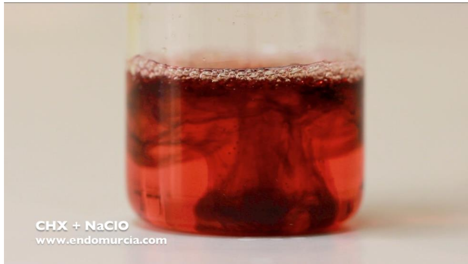
Figura 20: Precipitado color café-anaranjado llamado “paracloroanilina” formado al mezclar hipoclorito de sodio y gluconato de clorhexidina.
