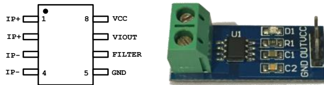
Figura 3-4 Sensor de corriente ACS712 y diagrama de pines [38].
