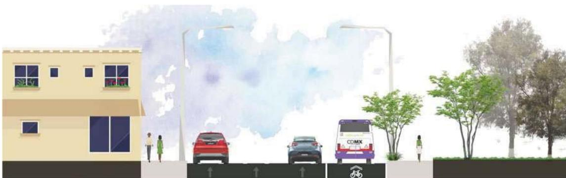
En el esquema se observa la fisonomía del Eje 7 Sur el cual es de un solo sentido vehicular (este-oeste). Tiene tres carriles para la circulación de automóviles particulares y un carril compartido por transporte público; trolebús y microbuses; y bicicletas.
