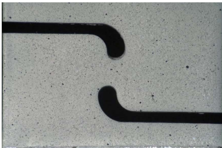
Figura 3.7. Acercamiento a la zona de interés de probeta 2mm45RD_1 preparada para su observación mediante DIC.
