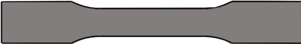
Figura 3.1. Geometría de una probeta para ensayo de tracción.
