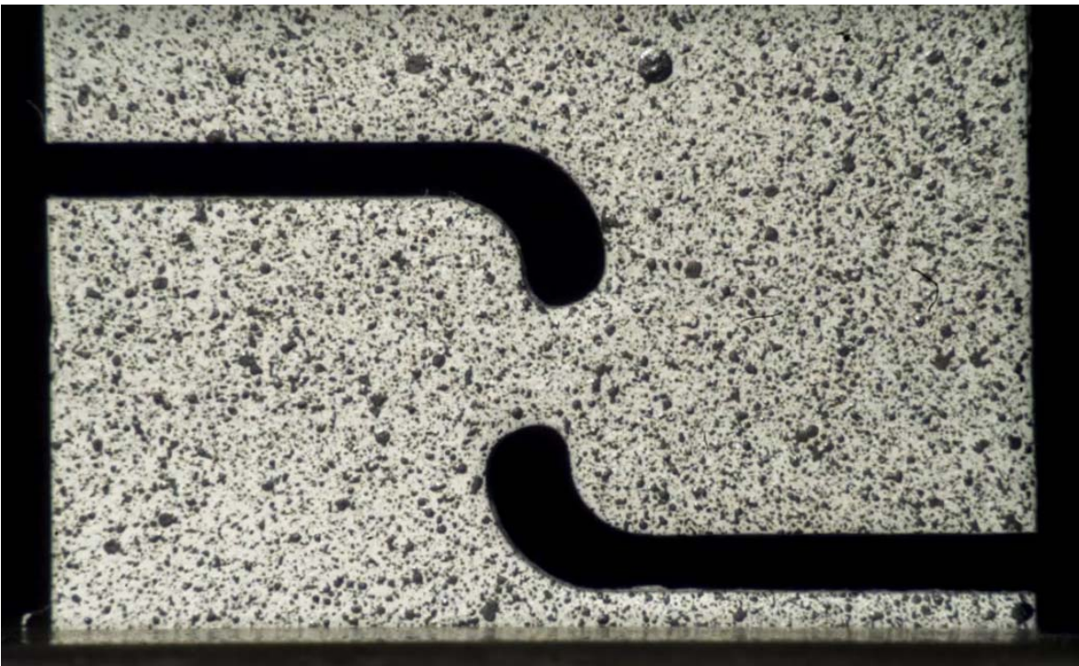
Figura 4.5. Probeta colocada en la máquina universal, preparada para observación en DIC .
