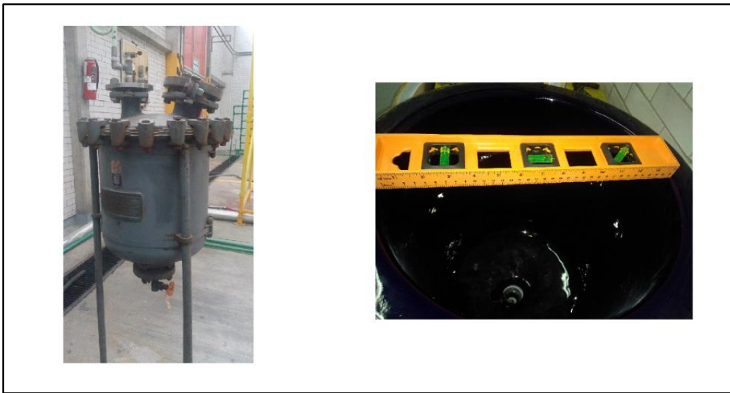
Figura 15. Reactor Pfaudler de 10 galones.
