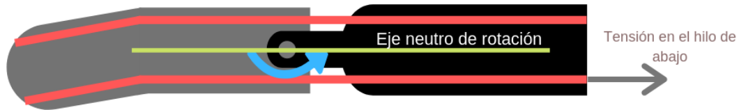
Ilustración 3.13. Muestra como al jalar el hilo de abajo, se genera un momento flector que permite que la falange distal gire hacia abajo, haciendo que la mano se cierra.
