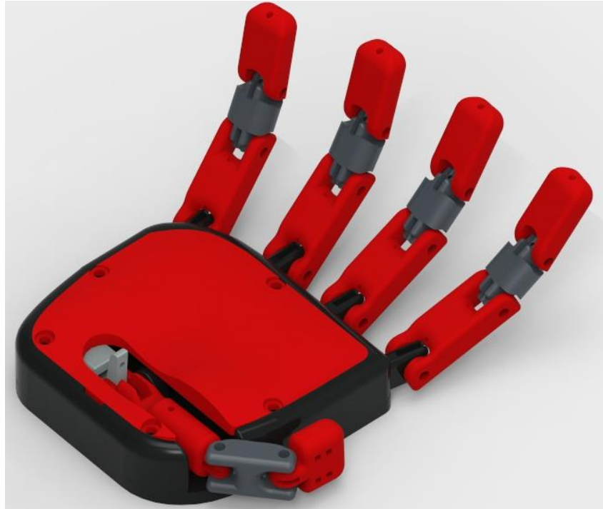
Figura 3.24. Ensamble de todas las piezas en el CAD final añadiendo una tapa a la palma.
