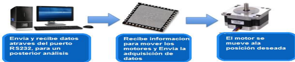
Fig. 2.13 Esquema General de la adquisición
