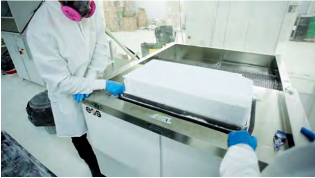
Proceso de extracción del bloque impreso en 3d.
