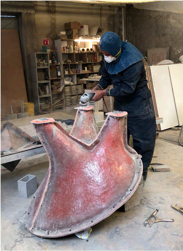
Desbaste con un esmeril para retirar el exceso de concreto que impedía abrir el molde.
