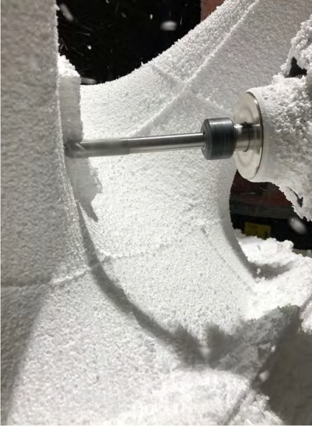
Proceso de maquinado del positivo de la silla para la fabricación del molde.
