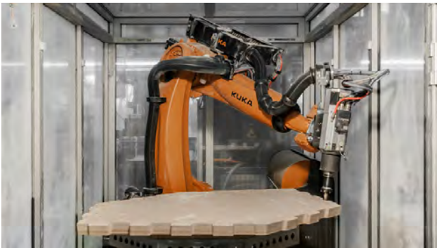
Proceso de fabricación de los bordes de los módulos mediante el uso de un brazo robótico.
