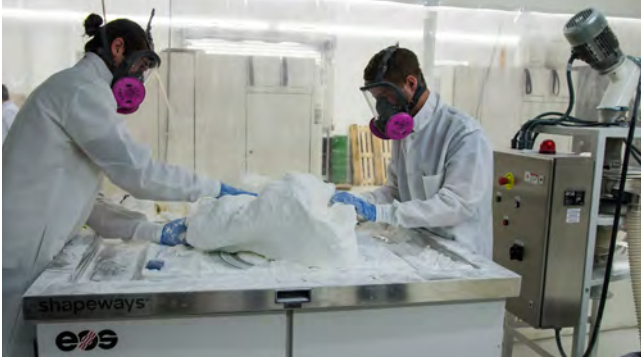
Proceso de limpieza del bloque general impreso en 3d para remover todo el exceso de material utilizado como soporte.
