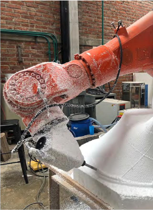
Punto crítico del maquinado de la pieza, en el cual se tuvo que reducir la velocidad del robot para evitar una posible colisión.
