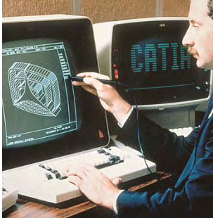
04-Interfaz de CATIA en 1982 para el diseño 3D y la programación de control numérico.
