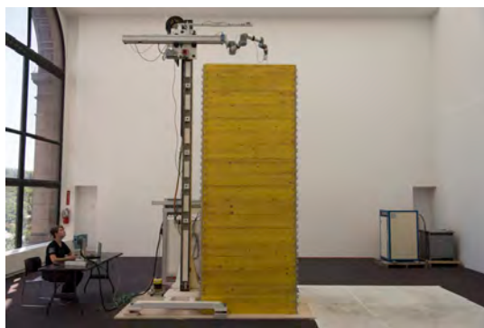
Colocación de la última capa de tejido.
