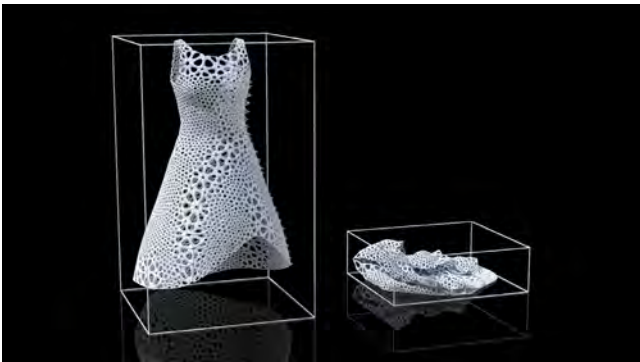
Gracias a las bisagras, el tamaño total del vestido puede ser impreso en una menor volumetría.
