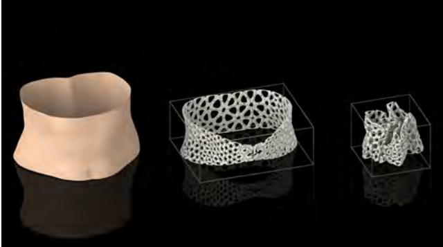
Diagrama que explica como se puede escanear el vientre de una perona para generar una pieza hecha a medida.
