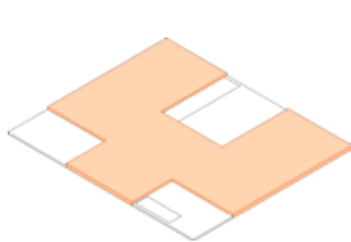
1. Losa de cimentación
