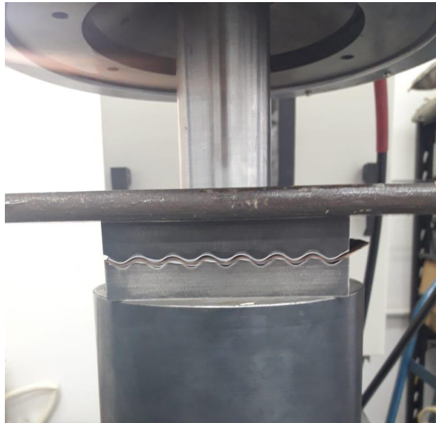
Figura 3.1. Imagen del proceso RCS en láminas de cobre utilizando placas de teflón.
