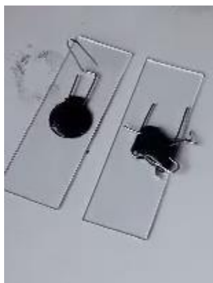
Figura 21. Aplicación de cianoacrilato negro, porta objetos y clip metálico
