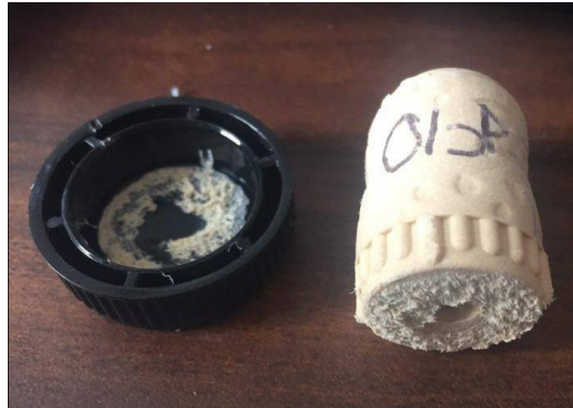
Figura 15. Fallo de sustrato (corcho sintético y tapa de polipropileno)
