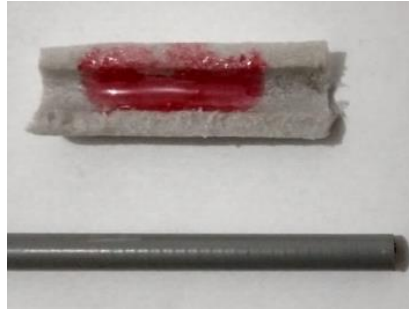
Figura 11. Separación por adhesión (cable con Policloruro de vinilo espumado)
