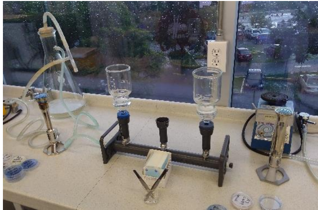
Figura 37. Sistema de filtración a vacío
