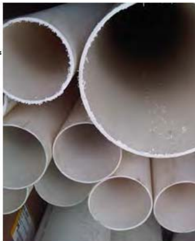
Tuberías de PVC. Foto ilustrativa. Imagen obtenida de Internet.
