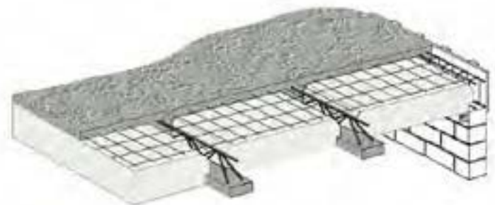
Sistema constructivo de entrepiso, de vigueta y bovedilla. Imagen obtenida de Internet.
