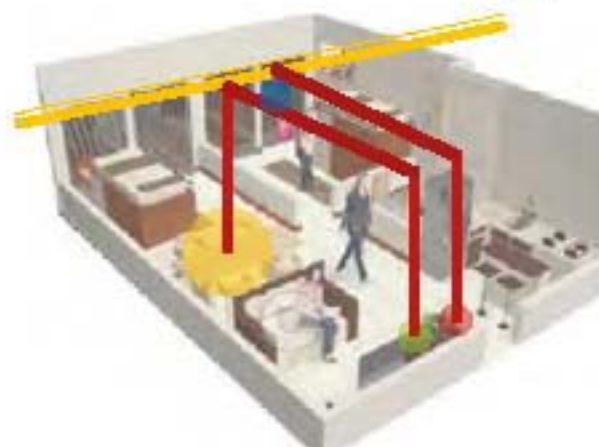
Instalación de voz y datos en Suite. Autoría propia.
