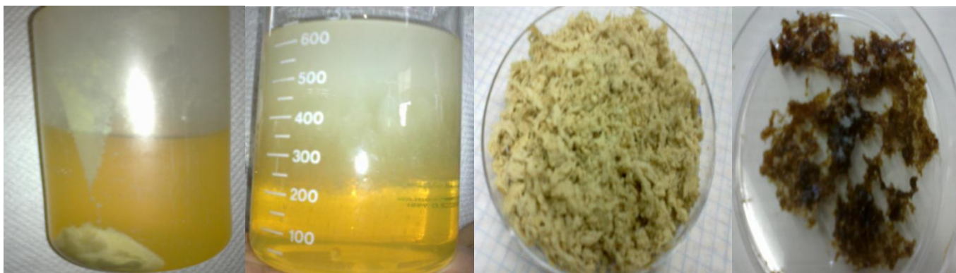
Figura 16. Separación de sedimentos del nejayote, formación del gel, xilano filtrado, xilano seco.
