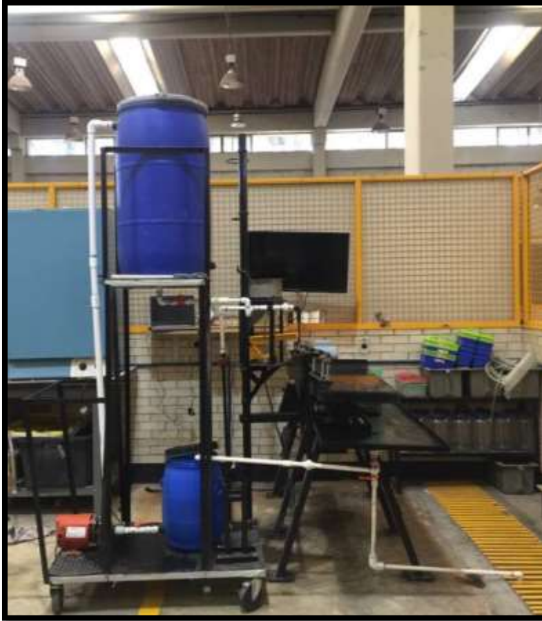
Figura 23. Sistema de recirculación de agua completo
