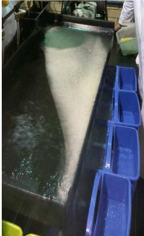
Figura 9. Formación de cama durante la concentración del mineral barita mediante mesa Wilfley.
