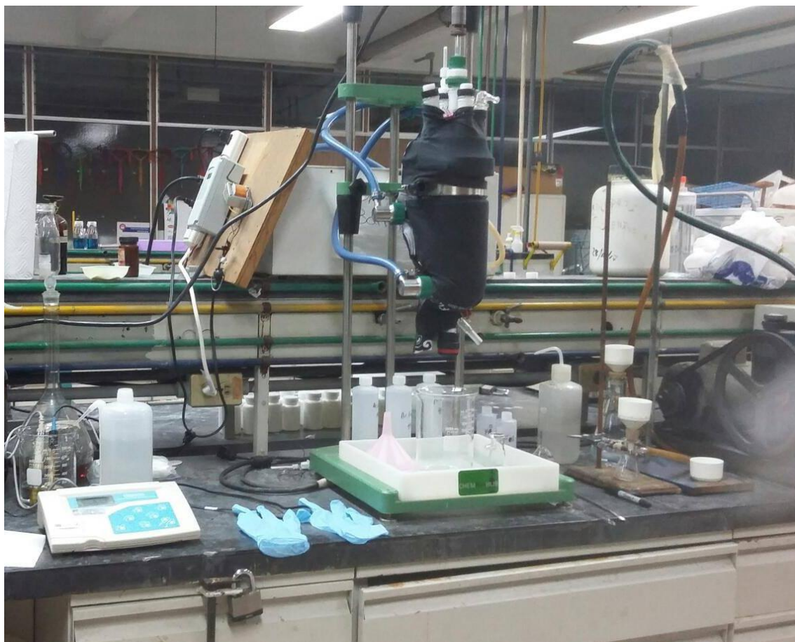
Figura 23. Equipos usados para los experimentos factoriales: reactor enchaquetado recubierto con tela negra, potenciómetro, bomba de vacío, matraz kitasato, soporte universal con pinza, pissetas con solución de aforo y agua destilada.
