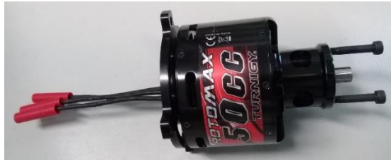
FIGURA 2.18 Motor eléctrico Turnigy Rotomax 50cc.
