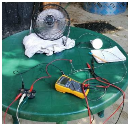
FIGURA 4.8 Foco de 12 [v] y ventilador conectados al puente rectificador trifásico.
