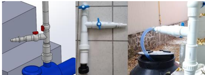
FIGURA 3.17 Salida del agua para medir flujo.
