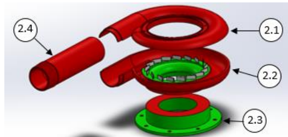
FIGURA 3.4 Voluta dividida en cuatro partes.
