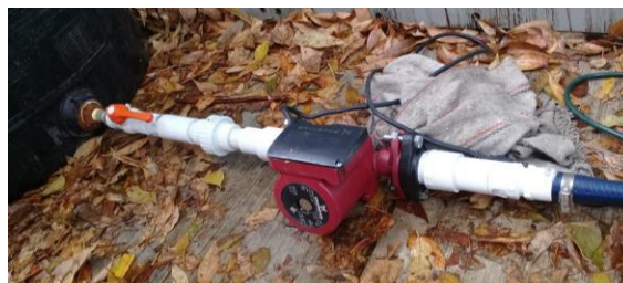
FIGURA 3.18 Bomba Grundfos UP26-99F 245 W.
