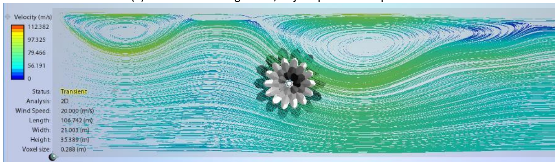
(b) Vista superior general, flujo representado por líneas
