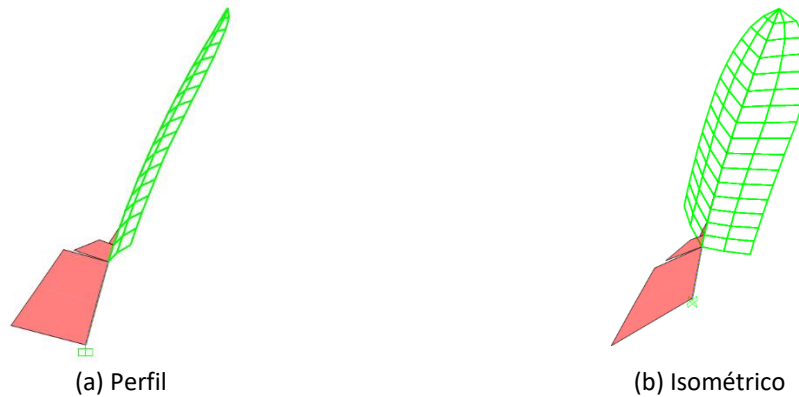
Figura C.3 Diagramas de momento en el peciolo de PVC como viga en cantiliver
