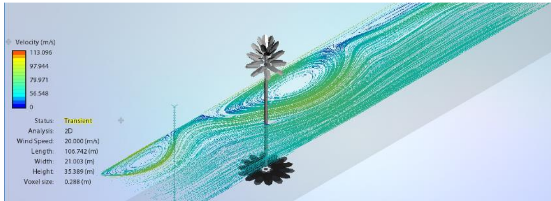
(a) Vista isométrica general, flujo representado por líneas
