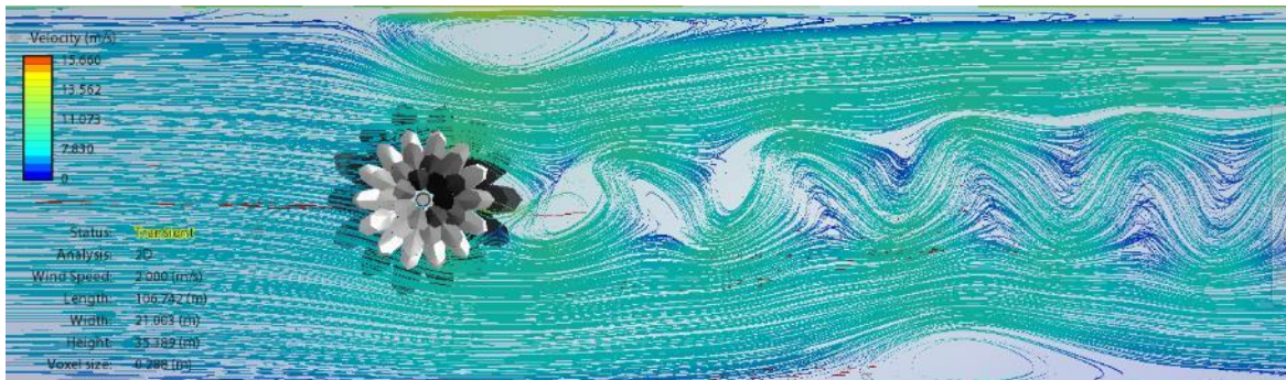
Figura 3.20 Calle de vórtices de Karman sobre el fuste del monopolo con R_e = 40 a 60
