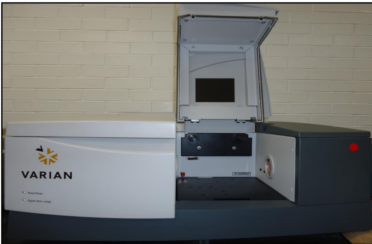
Fotografía 24- Equipo de FT-IR.
