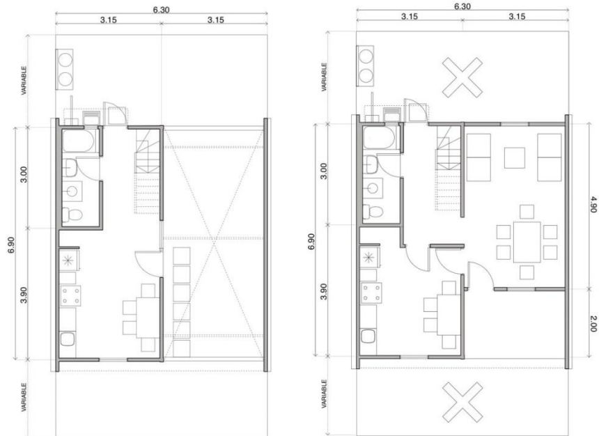
Gráfico 9. Izq. planta baja en primera etapa. Der. planta baja en segunda etapa. Fuente: (ELEMENTAL, 2013)
