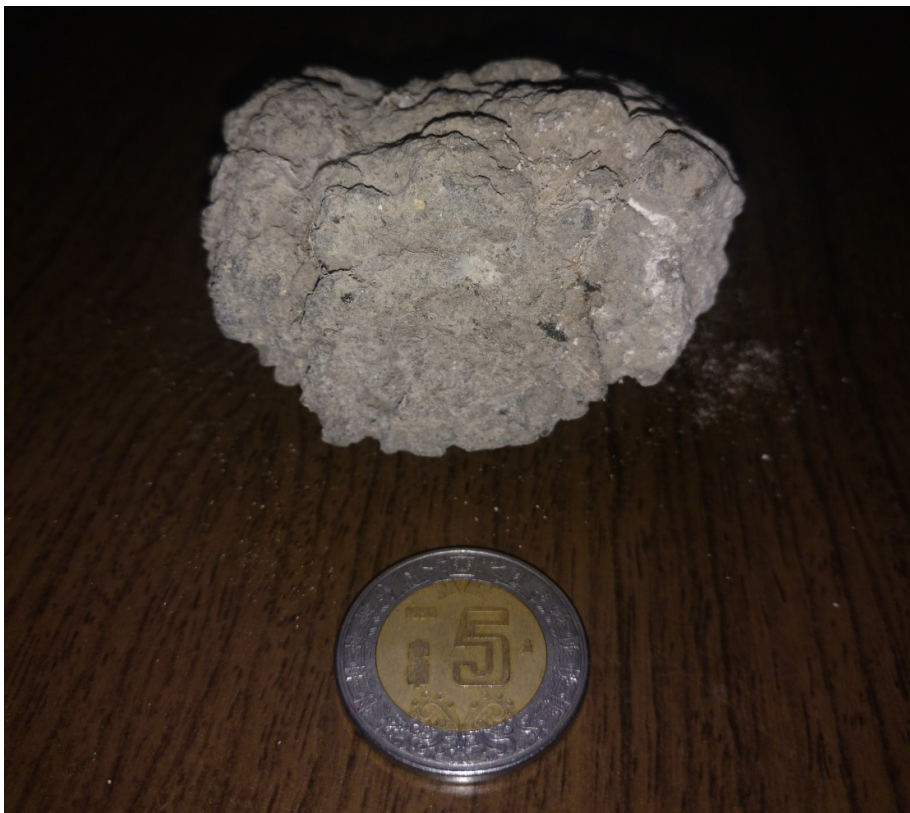
Figura 4.5. Muestra de roca de la pómez blanca de la estación dos; ISA-02.
