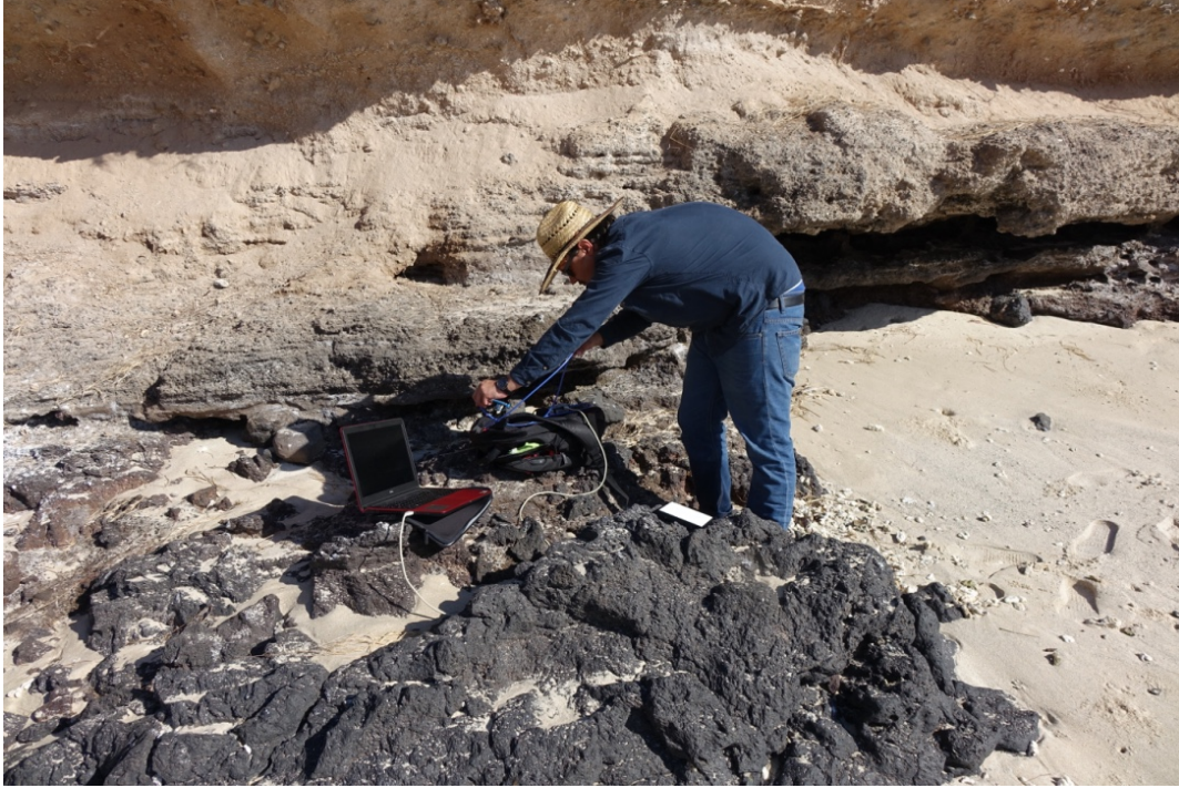
Figura 4.4. Se puede apreciar las dos unidades litológicas diferentes, el afloramiento de basaltos y en la parte superior la pómez blanca.
