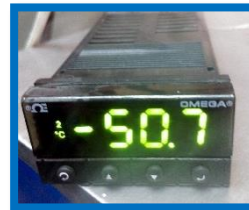
Fig. 57 Temperatura máxima y mínima medida por el termopar en las pruebas.
