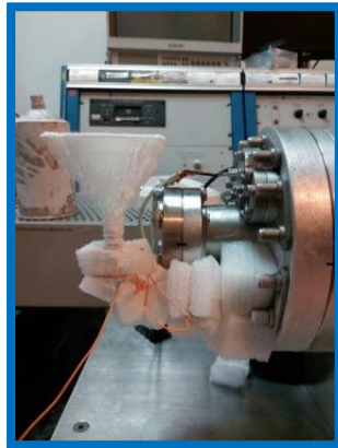
Fig. 54 Pruebas con nitrógeno líquido en el serpentin.
