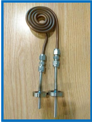
Fig. 52 Serpentin de 1/4 in de cobre y extensiones de acero inoxidable.
