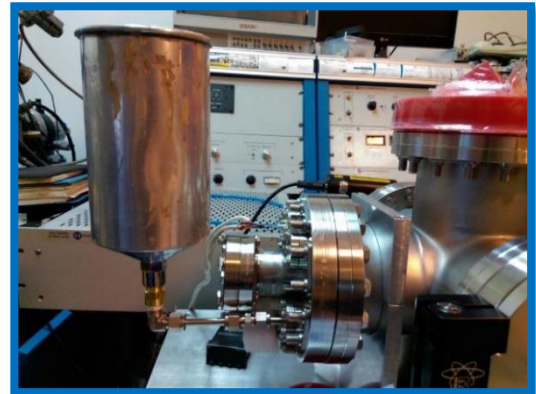
Fig. 55 Recipiente para el nitrógeno líquido instalado en la cámara.
