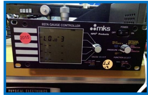
Fig. 45 Controlador de la marca MKS del medidor de alta presión.
