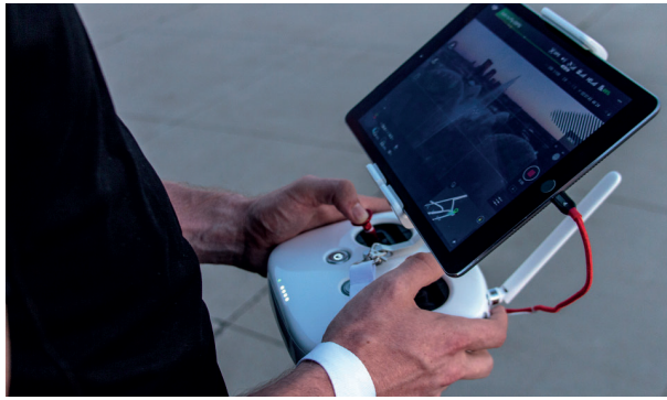
Ilustración 12. Controlador expandido gracias a la interconexión con un dispositivo portátil (Tablet) © DJI.
