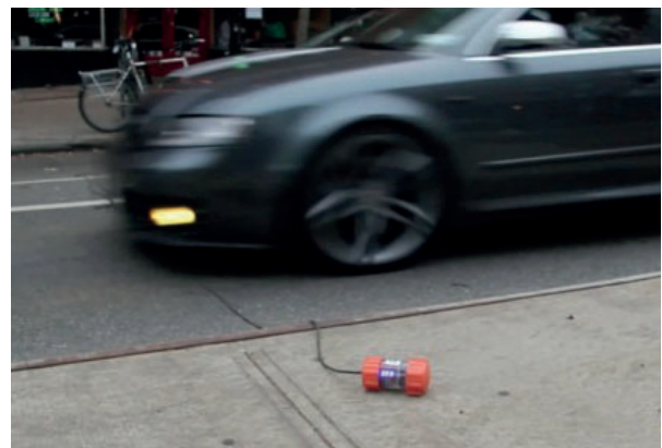
Ilustración 28. Método alternativo (dispositivo con sensores) para contar vehículos en sitio © trafficcom.
