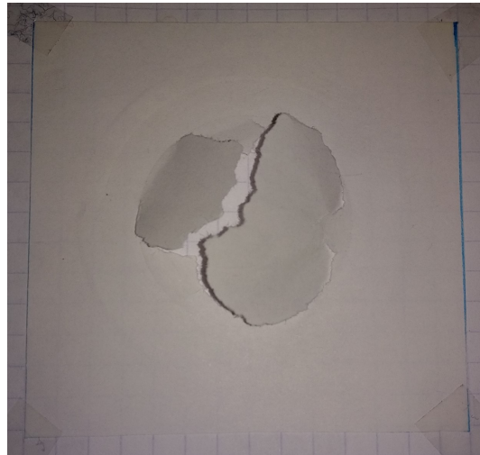
Figura 3.3: Membranas de papel Bond después de la ruptura.
