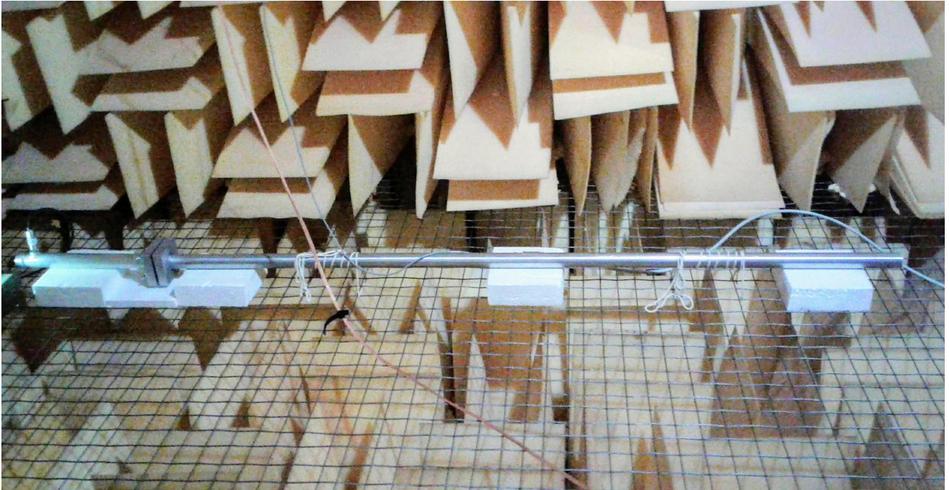
Figura 2.4: Tubo de choque dentro de la cámara anecoica.
