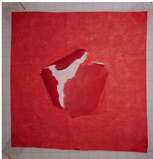
Figura 3.1: Membranas de papel china después de la ruptura.
