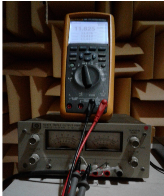
Figura 2.3: Fuente de poder y multímetro utilizados para la suministración de energía y adquisición de datos del transductor de presión.
