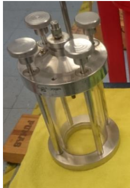
Figura 205 Cámara triaxial desmontada del marco de carga para colocación de la muestra de arcilla a ensayar. Laboratorio de la Facultad de Ingeniería, UNAM, 2017.
