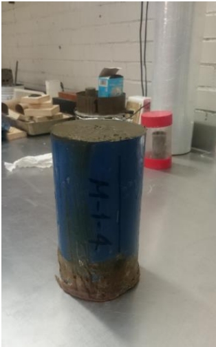
Figura 224 Tramo de tubo Shelby con la sección de muestra a ensayar. Laboratorio de mecánica de suelos de la Facultad de ingeniería (UNAM, 2017).
