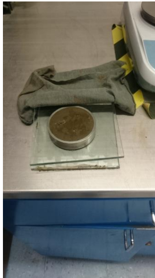
Figura 249 (Izquierda) Corte de la muestra de arcilla obtenida a los 6.15 m de profundidad, correspondiente al sitio de estudio, ubicado en Calle #23, colonia Prohogar, Delegación Azcapotzalco. Laboratorio de mecánica de suelos de la Facultad de Ingeniería (Universidad Nacional Autónoma de México, 2017).
