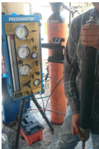
Figura 126. Purga del sistema. Presiómetro Ménard, marca APAGEO. MKE Ingeniería en suelos S.A. de C.V. (2017).
