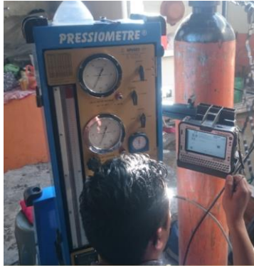
Figura 142. Aplicación de los escalones de presión desde la superficie, así como el control y seguimiento de la prueba con el sistema Geobox (para la adquisición de los datos presiométricos), marca APAGEO. MKE Ingeniería en suelos S.A. de C.V. (2017).
