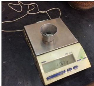
Figura 180 Determinación del contenido natural de agua (w%) de las muestras de arcilla correspondientes al área de estudio. Toma del peso húmedo de la muestra más la tara
