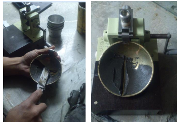
Figura 186 Preparación y colocación de las muestras de suelo en la copa de Cassagrande, con una ranura de 2 mm (inferior) a 13 mm (superior). Muestra de arcilla de alta plasticidad (CH), correspondiente al sitio de estudio, ubicado en calle 23, #232, Colonia Pro-hogar, Delegación Azcapotzalco.
