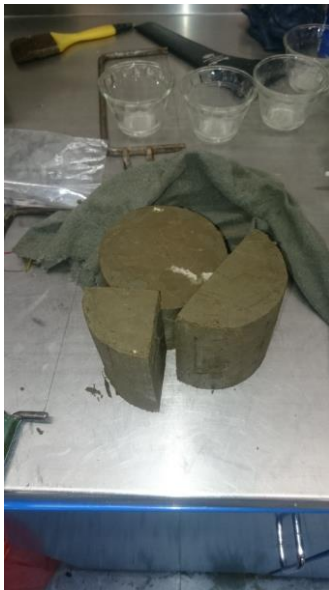
Figura 227 Seccionado de la muestra a ensayar en cuatro partes para obtención de las probetas. Laboratorio de mecánica de suelos de la Facultad de ingeniería (UNAM, 2017).
