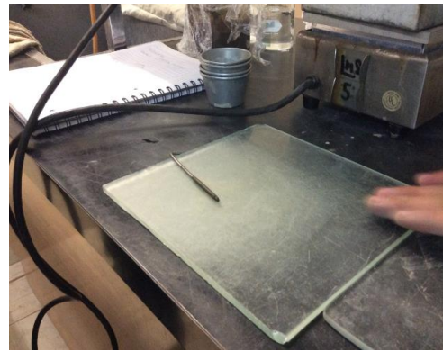
Figura 188 Rolado del suelo, para obtener un cilindro de 3 mm de diámetro. Muestra de arcilla de alta plasticidad (CH) de consistencia blanda, correspondiente al sitio de estudio, ubicado en calle 23, #232, Colonia Pro-hogar, Delegación Azcapotzalco.
