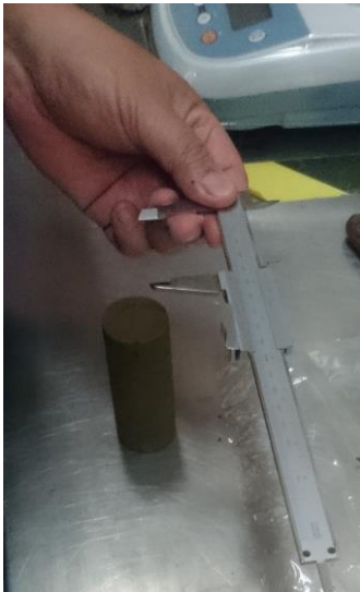
Figura 230 Medición de las dimensiones de las probetas a ensayar. Laboratorio de mecánica de suelos de la Facultad de ingeniería (UNAM, 2017).
