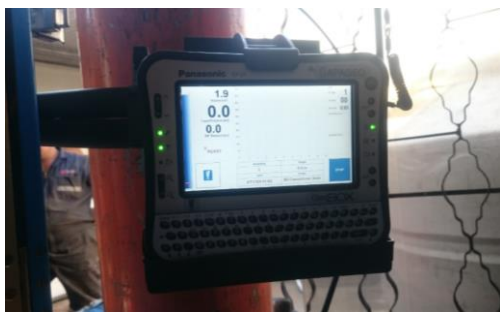
Figura 117. GeoBox, para la adquisición de los datos presiométricos, marca APAGEO. MKE Ingeniería de suelos, S.A. de C.V. (2017).
