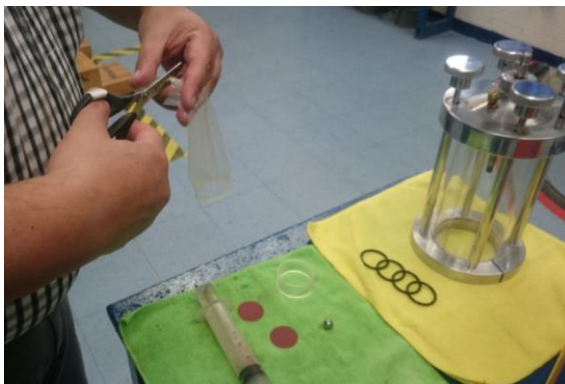
Figura 233 Preparación de cámara triaxial y membrana de látex; se aprecian aro-sellos, anillos de colocación de aro-sellos y membranas para evitar el drenaje durante la prueba. Laboratorio de mecánica de suelos de la Facultad de ingeniería (UNAM, 2017).
