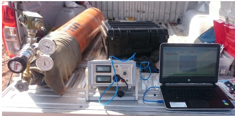
Figura 19 Unidad de Control para ensayos presiométricos con sonda presiométrica Elastómetro HQ.
