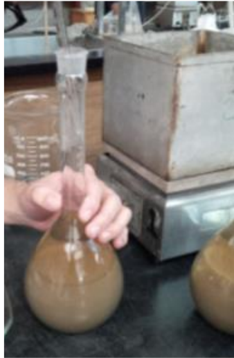
Figura 200 Aforo de los matraces una vez que el material se ha sedimentado. Muestra de arcilla de alta plasticidad (CH), color verde olivo, de consistencia blanda.
