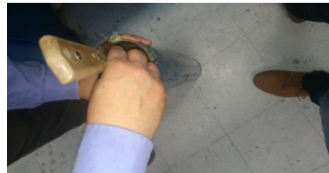
Figura 221 Enrasado de las superficies de la muestra contenida en el Tubo Shelby para ejecución de las pruebas de resistencia con Torcómetro y penetrómetro de bolsillo. Laboratorio de la Facultad de Ingeniería (UNAM, 2017).
