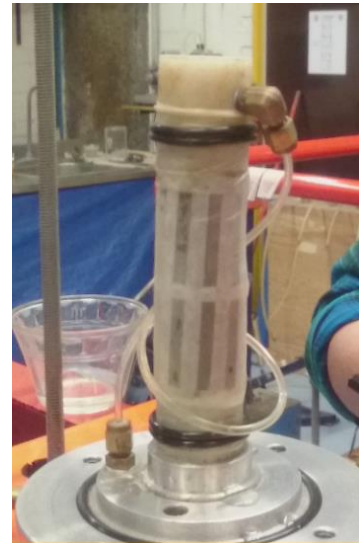
Figura 232 Colocación de aro-sellos y cabezal para aplicación de la contrapresión, \sigma_{cp} , por dren superior. Laboratorio de mecánica de suelos de la Facultad de ingeniería (UNAM, 2017).
