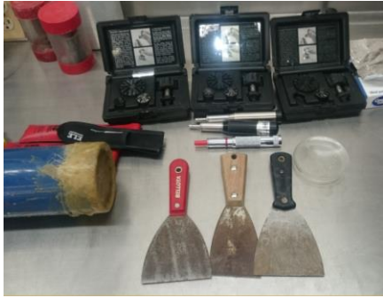
Figura 207 Penetrómetro y torcómetro de bolsillo para ensayos de resistencia, espátulas para corte de las muestras y labrado de las probetas. Laboratorio de mecánica de suelos de la Facultad de ingeniería (UNAM, 2017).
