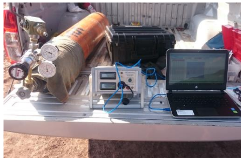
Figura 125. Tanque de nitrógeno para suministro de presión con conexión al lector de presión/deformación MOD. EL4 HQ y este a su vez, al Data Logger. HP ingeniería, suelos y cimentaciones, S.A. de C.V. (2017).
