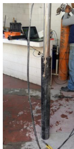
Figura 133. Calibración de la membrana por "Disminución de espesor de la goma de la camisa – Por la presión sobre la goma". Sonda Elastometer HQ en tubo de calibración de 76 mm. HP Ingeniería, suelos y cimentaciones, S.A. de C.V.
