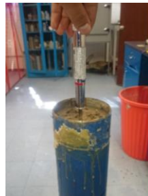
Figura 223 Estimación de la resistencia no drenada, c_u , con torcómetro y penetrómetro de bolsillo. Laboratorio de mecánica de suelos de la Facultad de ingeniería (UNAM, 2017).
