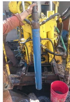
Figura 62. Obtención de muestra inalterada con muestreador tipo Shelby, en el área de estudio. HP Ingeniería, suelos y cimentaciones S.A. de C.V. (2017).
