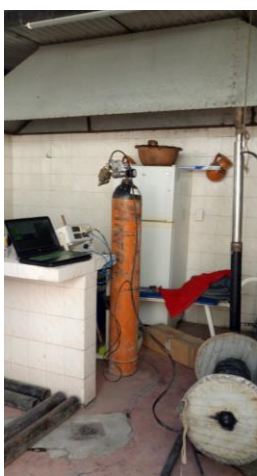
Figura 131. Adecuación de la sonda Elastometer HQ, para calibración de la membrana por la goma y 2.-Disminución de espesor de la goma de la camisa. HP Ingeniería, suelos y cimentaciones, S.A. de C.V. (2017).
