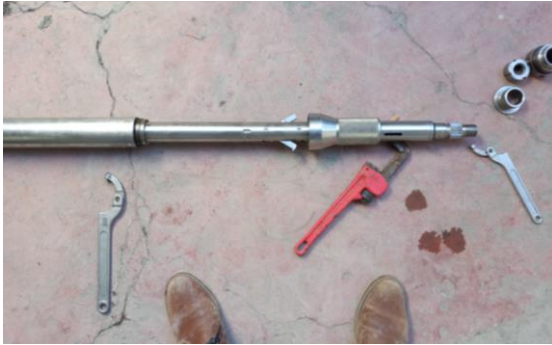
Figura 120. Sonda presiométrica monocelular HQ, 70 mm de diámetro, con sensor en forma de pinza, marca OYO Elastómetro, modelo 4180. HP ingeniería, suelos y cimentaciones, S.A. de C.V. (2017).
