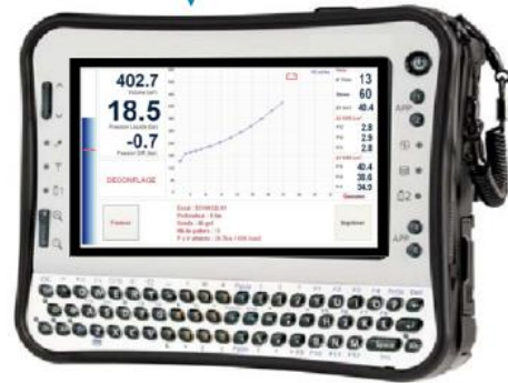
Figura 18 Seguimiento del ensayo en tiempo real con GeoBox (APAGEO, 2015).
