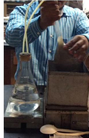
Figura 199 Agitado de los matraces durante la aplicación del vacío. Muestra de arcilla de alta plasticidad (CH), color verde olivo, de consistencia blanda.
