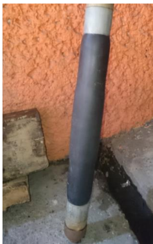
Figura 127. Calibración de la membrana por pérdida de presión. Sonda tipo Ménard, marca APAGEO. MKE Ingeniería en suelos S.A. de C.V. (2017).
