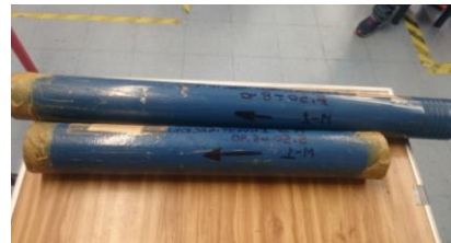
Figura 63. Muestras debidamente protegidas con cinta canela y cera, para su traslado a laboratorio. HP Ingeniería, suelos y cimentaciones S.A. de C.V. (2017).
