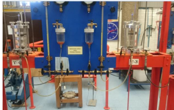
Figura 206 Cámaras triaxiales montadas en marco de carga para la realización de una serie de compresión triaxial UU a las muestras de arcilla correspondientes al sitio de estudio (Colonia Pro-hogar, Delegación Azcapotzalco). Se aprecia compresor de aire, porta pesas, juego de buretas y válvulas de cierre rápido, Laboratorio de la Facultad de Ingeniería, UNAM, 2017.
