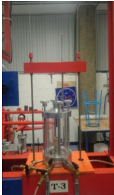
Figura 204 Cámara triaxial para ejecución de las pruebas de compresión simple q_u , triaxial UU y CU . Laboratorio de la Facultad de Ingeniería, UNAM, 2017.
