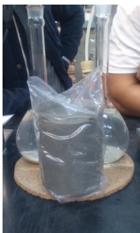
Figura 195 Arcilla de alta plasticidad (CH) color verde olivo y consistencia blanda, homogenizada, en reposo por 24 hr. Correspondiente al sitio de estudio, (Calle 23, #232, Colonia Pro-hogar, Delegación Azcapotzalco).
