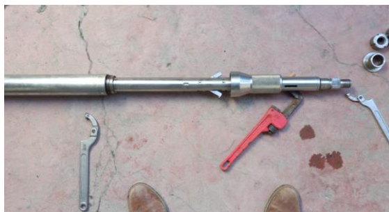
Figura 129. Verificación de medida de Radio, Sonda Elastómetro HQ en anillo de calibración, maca OYO Model-4180. HP Ingeniería, suelos y cimentaciones, S.A. de C.V. (2017).
