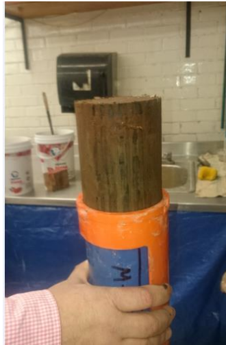
Figura 225 Extracción de la sección de muestra a ensayar del tramo de tubo Shelby. Laboratorio de mecánica de suelos de la Facultad de ingeniería (UNAM, 2017).
