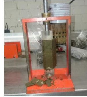
Figura 209 Torno para labrado de probetas. Muestra de arcilla de alta plasticidad (CH). Laboratorio de mecánica de suelos de la Facultad de ingeniería (UNAM, 2017).
