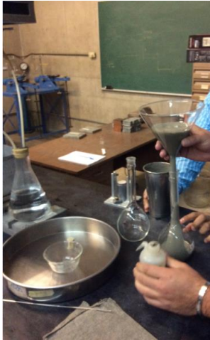
Figura 197 Llenado de los matraces con la suspensión del material. Muestra de arcilla de alta plasticidad (CH), color verde olivo, de consistencia blanda.
