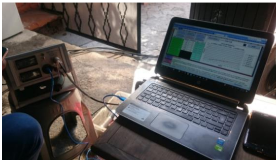
Figura 124. Lector de presión/deformación MOD. EL4 y Data logger (Computadora portátil). HP ingeniería, suelos y cimentaciones, S.A. de C.V. (2017).
