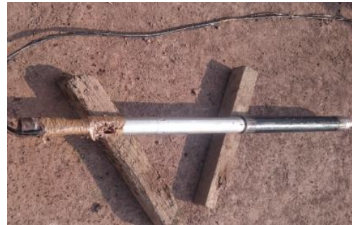
Figura 123. Sonda presiométrica monocelular Elastómetro HQ, con membrana blanda de 76 mm de diámetro. HP ingeniería, suelos y cimentaciones, S.A. de C.V. (2017).
