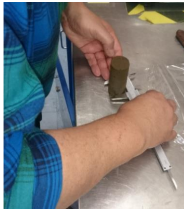
Figura 192 Dimensiones de la probeta, para determinar su volumen. Muestra de arcilla de alta plasticidad (CH), color verde olivo, de consistencia blanda.
