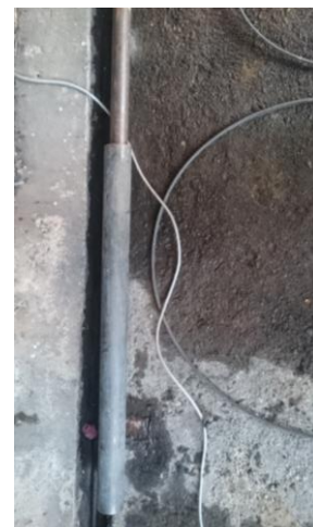
Figura 128. Sonda tipo Ménard dentro de tubo de acero para calibración de la membrana por pérdida de volumen. MKE Ingeniería en suelos S.A. de C.V. (2017).
