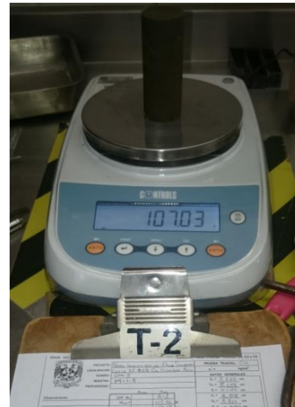
Figura 229 Pesaje de las probetas de ensaye. Laboratorio de mecánica de suelos de la Facultad de ingeniería, (UNAM, 2017).
