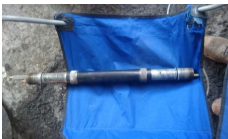
Figura 115. Sonda presiométrica tricelular BX, diámetro nominal de 60 mm, marca APAGEO; celdas central y de guarda. MKE Ingeniería de suelos, S.A. de C.V. (2017).
