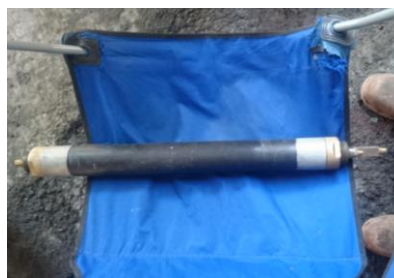
Figura 116. Sonda presiométrica tricelular BX, diámetro nominal de 60 mm, marca APAGEO; colocación de la membrana flexible, para pruebas en suelos blandos. MKE Ingeniería de suelos, S.A. de C.V. (2017).
