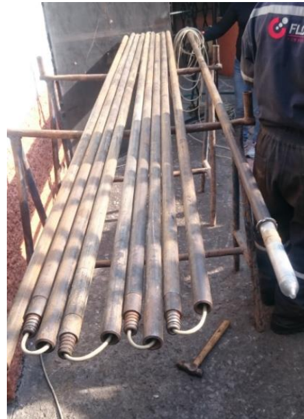
Figura 65. Preparación del Piezocono, cable blindado múltiple y tubería auxiliar de perforación, para ejecución de la prueba. HP Ingeniería, suelos y cimentaciones S.A. de C.V. (2017).
