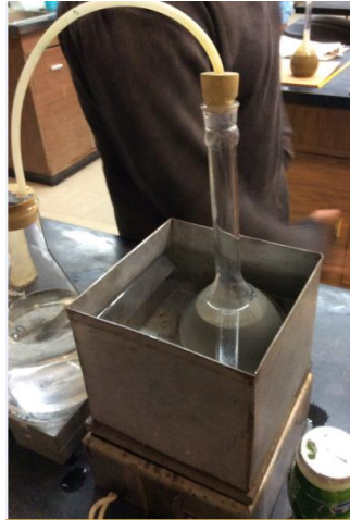
Figura 198 Desaireado de la suspensión de material. Muestra de arcilla de alta plasticidad (CH), color verde olivo, de consistencia blanda.
