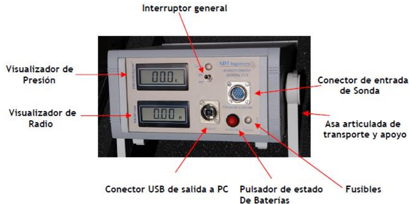
Figura 20 Instrumento acondicionador o Lector de presión/ deformación radial para presiómetro Elastometro HQ 4180
