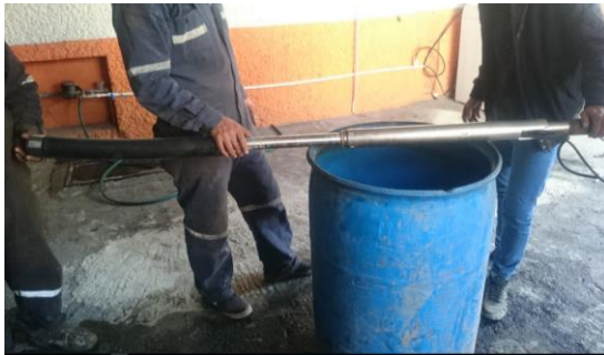
Figura 122. Colocación de la membrana blanda de 76 mm de diámetro en la sonda monocelular Elastómetro HQ. HP ingeniería, suelos y cimentaciones, S.A. de C.V. (2017).
