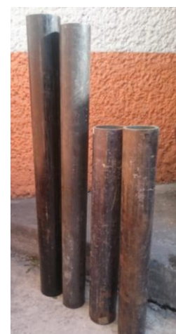
Figura 134. Tubos de calibración de 76 mm, 80, 85 y 90 mm para la calibración de la membrana por "Disminución de espesor de la goma de la camisa – Por la expansión dimensional de la camisa". Sonda Elastometer HQ. HP Ingeniería, suelos y cimentaciones, S.A. de C.V. (2017).
