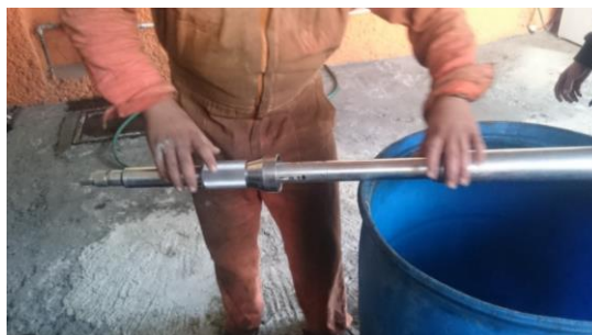
Figura 130. Verificación de medida de Radio, Sonda Elastómetro HQ en anillo de calibración, maca OYO Model-4180. HP Ingeniería, suelos y cimentaciones, S.A. de C.V. (2017).
