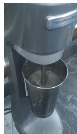
Figura 196 Arcilla de alta plasticidad (CH) color verde olivo y consistencia blanda, en mezcladora para formar una suspensión. Correspondiente al sitio de estudio, (Calle 23, #232, Colonia Pro-hogar, Delegación Azcapotzalco).
