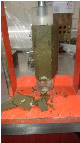
Figura 228 Corte y labrado de las probetas de ensaye en torno de labrado. Laboratorio de mecánica de suelos de la Facultad de ingeniería, (UNAM, 2017).
