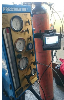
Figura 118. Controlador de presión-volumen (CPV) con reguladores de presión, válvula diferencial y manómetros; GeoBox, marca APAGEO; tanque de gas comprimido. MKE Ingeniería de suelos, S.A. de C.V. (2017).
