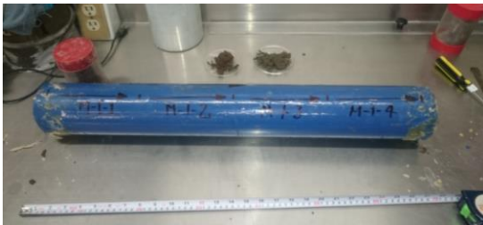
Figura 220 Seccionamiento del tubo Shelby, para extracción de la muestra que se desea ensayar. Laboratorio de la Facultad de Ingeniería (UNAM, 2017).
