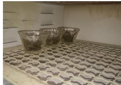
Figura 181 Determinación del contenido natural de agua (w%) de las muestras de arcilla correspondientes al área de estudio. Secado de muestras en el horno a 110^{\circ} \pm 5^{\circ}\text{C} .
