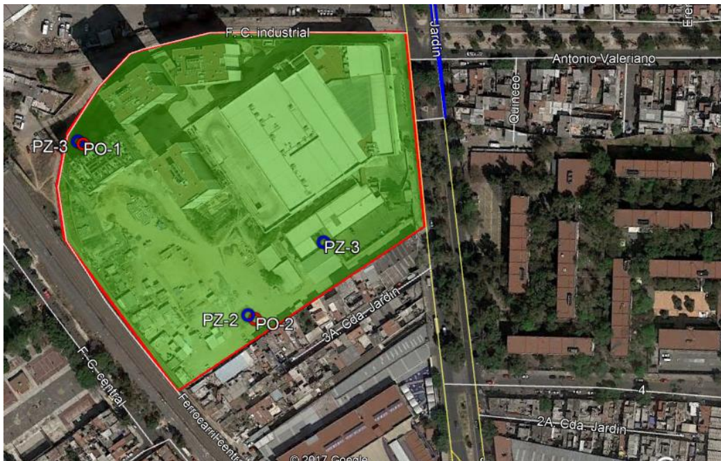
Figura 58. Localización de piezómetros (PZ) y pozos de observación (PO) dentro del proyecto en Av. Jardín, Delegación Azcapotzalco. MKE Ingeniería en suelos S.A. de C.V., 2016; Google Earth (2005).
