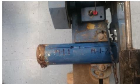
Figura 222 Corte del Tubo Shelby, para obtención de la sección de muestra a ensayar. Laboratorio de mecánica de suelos de la Facultad de ingeniería (UNAM, 2017).
