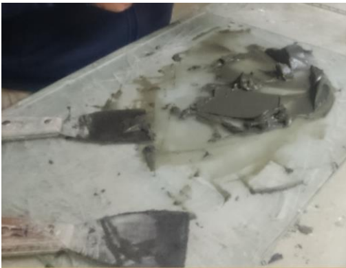
Figura 187 Preparación de la muestra; extendido, remoldeo y secado. Muestra de arcilla de alta plasticidad (CH) de consistencia blanda, correspondiente al sitio de estudio, ubicado en calle 23, #232, Colonia Pro-hogar, Delegación Azcapotzalco.
