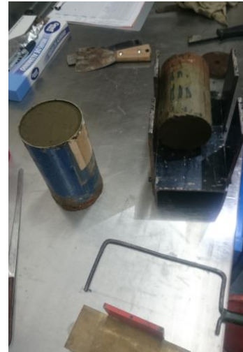
Figura 226 Tramo de tubo Shelby con sección de muestra a ensayar y muestra extraída en cabeceador de muestras. Laboratorio de mecánica de suelos de la Facultad de ingeniería (UNAM, 2017).
