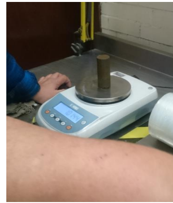
Figura 193 Determinación del peso de la probeta para pruebas de compresión Triaxial. Muestra de arcilla de alta plasticidad (CH), color verde olivo, de consistencia blanda.
