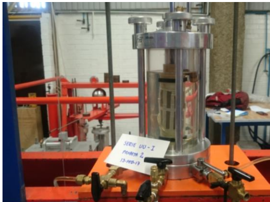
Figura 237 Probeta de arcilla a la falla y vaciado de la cámara triaxial. Laboratorio de mecánica de suelos de la Facultad de ingeniería (UNAM, 2017).
