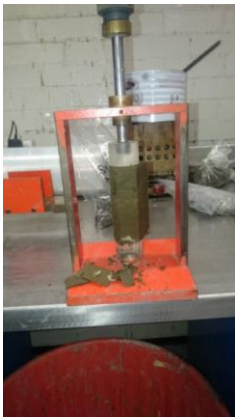
Figura 191 Labrado de las probetas para ensayos de compresión Triaxial. Muestra de arcilla de alta plasticidad (CH), color verde olivo, de consistencia blanda.
