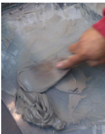
Figura 194 Homogenización de la muestra de arcilla de alta plasticidad (CH), color verde olivo, de consistencia blanda. Correspondiente al sitio de estudio, (Calle 23, #232, Colonia Pro-hogar, Delegación Azcapotzalco).
