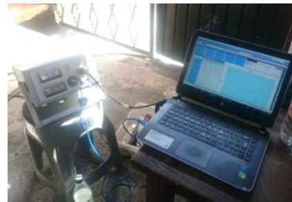
Figura 145. Control y monitoreo de la ejecución de la prueba, a partir de la conexión "Lector de presión/deformación MOD. EL4 HP - Data Logger o Laptop". HP Ingeniería, suelos y cimentaciones, S.A. de C.V. (2017).
