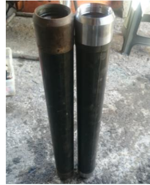
Figura 121. Camisa dura NX (200 bar) y camisa blanda NX (50 bar), ambas de 74 mm de diámetro. HP ingeniería, suelos y cimentaciones, S.A. de C.V. (2017).
