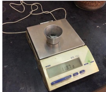
Figura 190 Registro del peso del material obtenido de la prueba del límite plástico. Muestra de arcilla de alta plasticidad (CH) de consistencia blanda, correspondiente al sitio de estudio, ubicado en calle 23, #232, Colonia Pro-hogar, Delegación Azcapotzalco.
