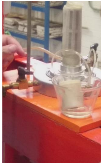
Figura 231 Instalación de la probeta sobre el pedestal de la cámara triaxial; colocación de la membrana de látex y rejilla de filtro en la probeta a ensayar. Laboratorio de mecánica de suelos de la Facultad de ingeniería (UNAM,
