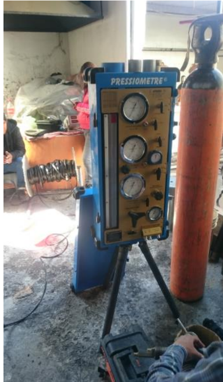
Figura 119. Controlador de presión-volumen (CPV) marca APAGEO, con reguladores de presión, válvula diferencial y manómetros; tanque de gas comprimido. MKE Ingeniería de suelos, S.A. de C.V. (2017).
