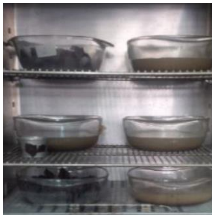
Figura 202 Recipientes de vidrio con el contenido de los matraces dentro del horno de convección. Muestra de arcilla de alta plasticidad (CH), color verde olivo, de consistencia blanda.
