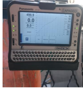
Figura 143. Adquisición de los datos presiométricos y registro automático de las condiciones y los resultados del ensaye; visualización de la curva esfuerzo-deformación bruta y seguimiento de la prueba con el sistema Geobox, marca APAGEO. MKE Ingeniería en suelos S.A. de C.V. (2017).
