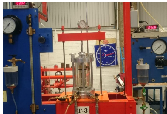
Figura 234 Colocación de la cámara triaxial y llenado con agua de la misma. Se observa micrómetro para medición de las deformaciones durante la prueba. Laboratorio de mecánica de suelos de la Facultad de ingeniería (UNAM
