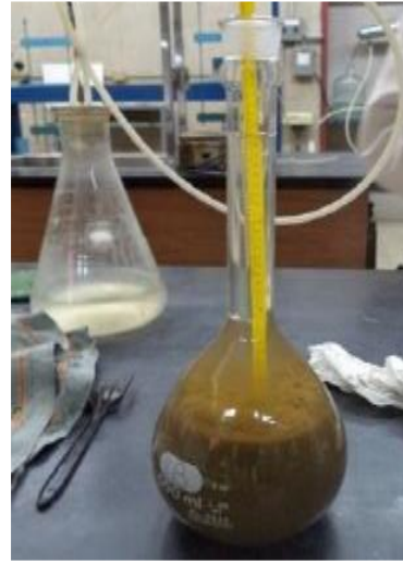
Figura 201 Toma de la temperatura al interior del matraz. Muestra de arcilla de alta plasticidad (CH), color verde olivo, de consistencia blanda.
