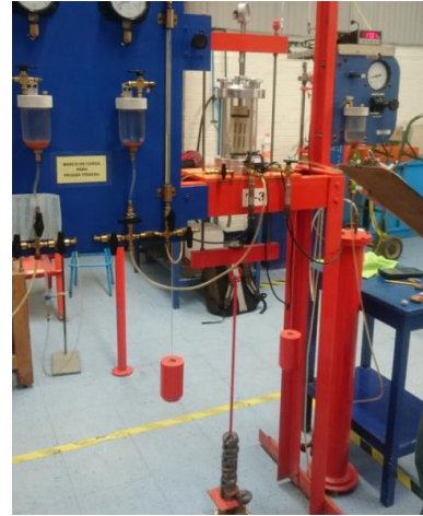
Figura 236 Aplicación de los incrementos de carga en el contrapesas. Laboratorio de mecánica de suelos de la Facultad de ingeniería (UNAM, 2017).
