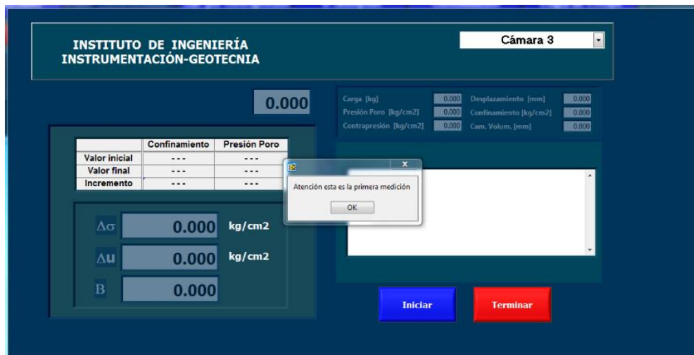
Figura 4. 3.- Ventana para el procedimiento de medición de la B de Skempton.
