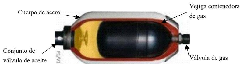
*Imagen 4.50.* Vista en corte de un acumulador de botella o de vejiga. Imagen tomada de <http://oleohidraulica.hydrindustry.com/recomendaciones-y-parametros-de-trabajo-para-acumuladores-oleohidraulicos/> para fines educativos,
