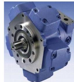
*Imagen 4.49.* El grafico se muestra el ensamble de un motor hidráulico, en el se puede observar un eje que gira excéntrico para mover las bielas de cada pistón y generar la carga y descarga correspondiente en cada giro (Imágenes tomadas de [http://home.kpn.nl/RBrink1955/radpm\\_esp.htm](http://home.kpn.nl/RBrink1955/radpm_esp.htm) para fines educativos).
