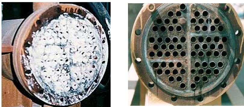
*Imagen 6.8.* A la izquierda, fluxes de un intercambiador completamente saturado de impurezas, a la derecha, un intercambiador con los fluxes óptimos y limpios para realizar su función. (Imagen tomada de <https://english.hydroflowcaribe.com/tecnologia/depositos/> para fines educativos)
