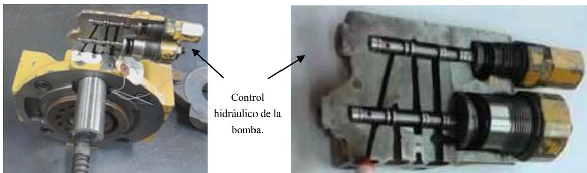
*Imagen 4.18.* Vista en corte del control hidráulico de la bomba de caudal variable. ( Imagen de la izquierda tomada de REXROTH LOAD SENSING DRF DFR PUMP CONTROL EXPLAINED PART 2 <https://youtu.be/Fb8o-9b4Mrc> Imagen de la derecha tomada de REXROTH LOAD SENSING DRF DFR PUMP CONTROL EXPLAINED PART 1 <https://www.youtube.com/watch?v=0LIFzZY1OuU> para fines educativos).
