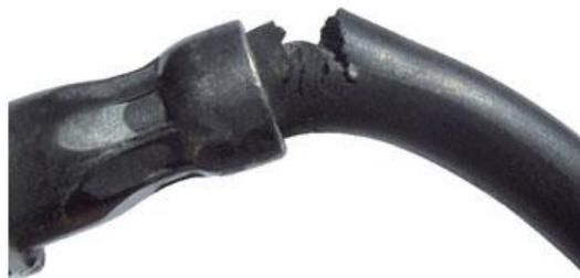
*Imagen 6.7.* Emsamble de manguera dañado por exposición a alta temperatura y colocación con un dobles inadecuado. (Imagen tomada de <http://www.confiumaq.cl/index.php?mostrar=submenu&ver=14> para fines educativos)
