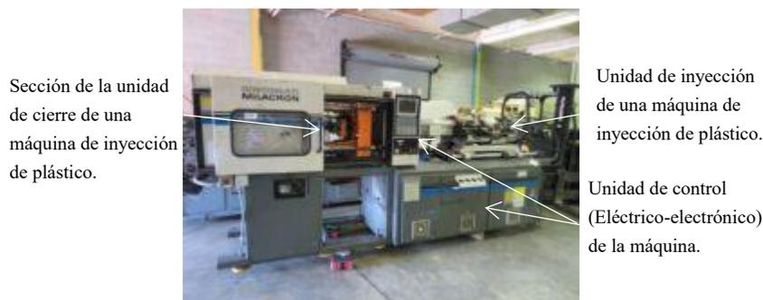
*Imagen 3.2* Vista del lado operador de una máquina de inyección. (Imagen tomada de <https://www.machinio.com/listings/32072833-1994-cincinnati-milacron-vt110-10-in-gibsonville-nc> para fines educativos).
