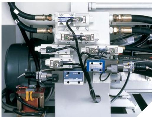
Imagen 4.21. Múltiple hidráulico. Se observan acopladas a él, diversas válvulas y conexiones. (Imagen tomada de <http://iml-robots.com/asian-plastic-machinery-hydraulic-clamping.php> para fines educativos).
