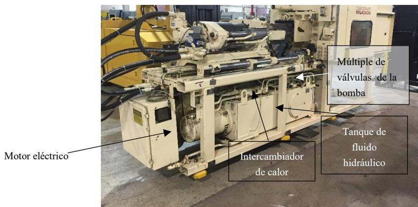
*Imagen 4.7.* Imagen física de un tanque hidráulico. Nota. Las bombas no son visibles debido a que están dentro del tanque. (Imagen tomada de [http://s3.amazonaws.com/idealm\\_img/77000/77191/IMG\\_5686.JPG](http://s3.amazonaws.com/idealm_img/77000/77191/IMG_5686.JPG) para fines educativos).
