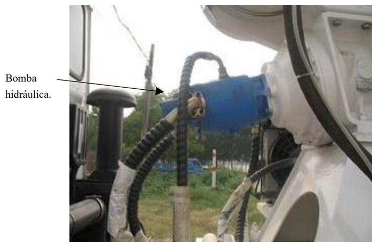
*Imagen 2.1.* Ensamble de bomba hidráulica y reductor en una auto hormigonera. (Imagen tomada de <https://crete.com.co/ollas-para-camion/para-fines-educativos>).
