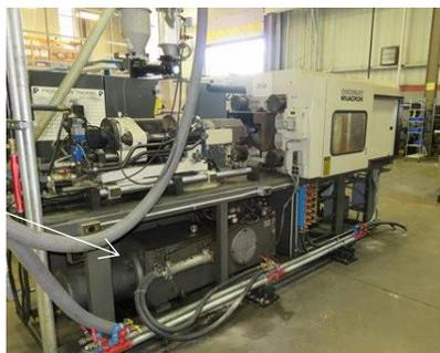
*Imagen 3.3.* Vista lado contrario a operador de una máquina de inyección. (Imagen tomada de <https://portal-images.azureedge.net/auctions-2016/bscm10278/images/b226c9a9-a3b8-4c57-e4ed-5894f3d209e8.jpg?w=540&h=360> para fines educativos).
