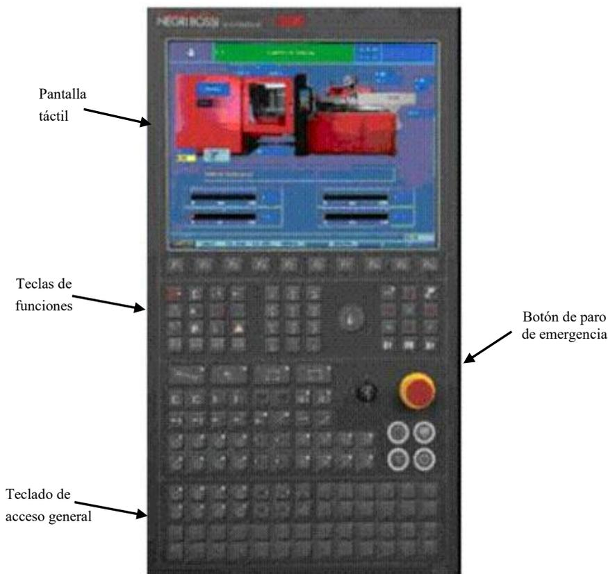
Imagen 3.10. Tablero de control moderno. (Imagen tomada de <http://tecnologiadelosplasticos.blogspot.com/2011/06/inyeccion-de-materiales-plasticos-i.html> para fines educativos).
