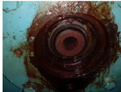
*Imagen 6.1.* Izquierda, flecha estriada de bomba hidráulica. Derecha, alojamiento de acoplamiento estriado desgastado. (Imágenes tomadas de <https://yocuidomiequipo.wordpress.com/2018/11/05/desgaste-eje-estriado-bomba-hidraulica-caja-multiplicadora/> para fines educativos).
