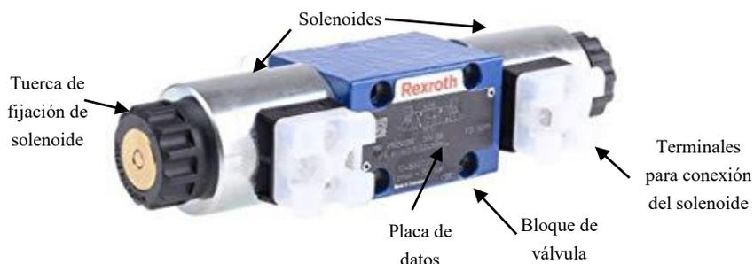
Imagen 4.22. Válvula direccional de carrete 4 vías 3 posiciones con regreso a resorte, típica de la firma Bosch Rexroth. (Imagen tomada de <https://www.amazon.es/Bosch-r900561288-eg24-N9-K4-direccional-hidr%C3%A1ulico-funcionamiento/dp/B0711FH4FL> para fines educativos).
