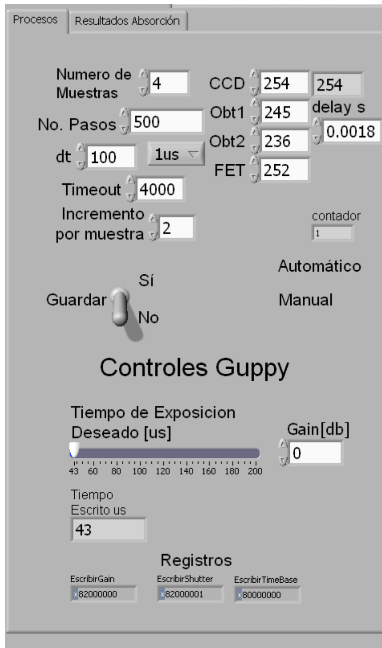
Figura 31: Parte del programa donde se controlan los parámetros de tiempo a usar en la adquisición de imágenes, controlando los obturadores y la cámara CCD
