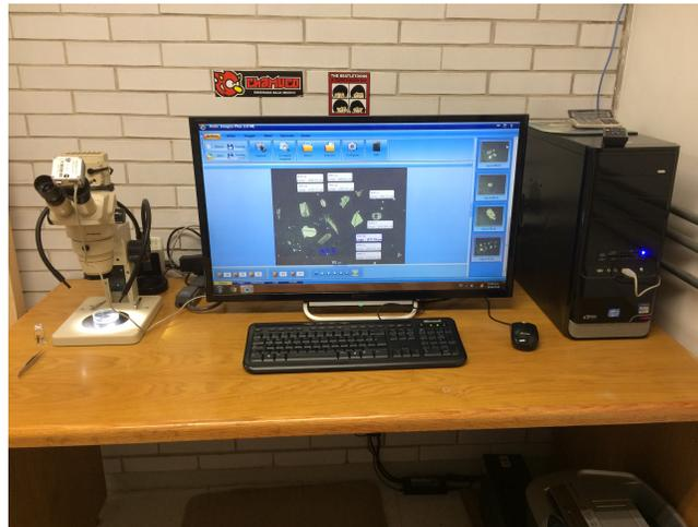
Figura 4.7 Equipo computarizado para la medición de MP
