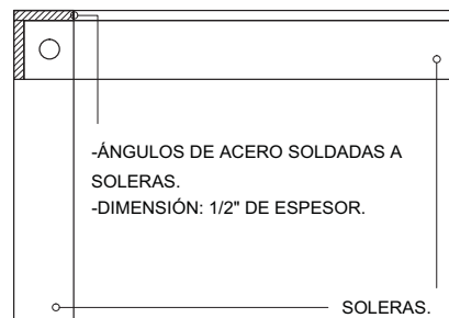
DETALLE DE ÁNGULO ESC:1:10
